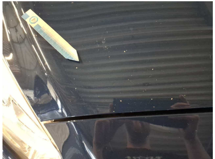
Damage 13: Bonnet: Bonnet (Sandstrahleffekt) - Stone chips - Paint
