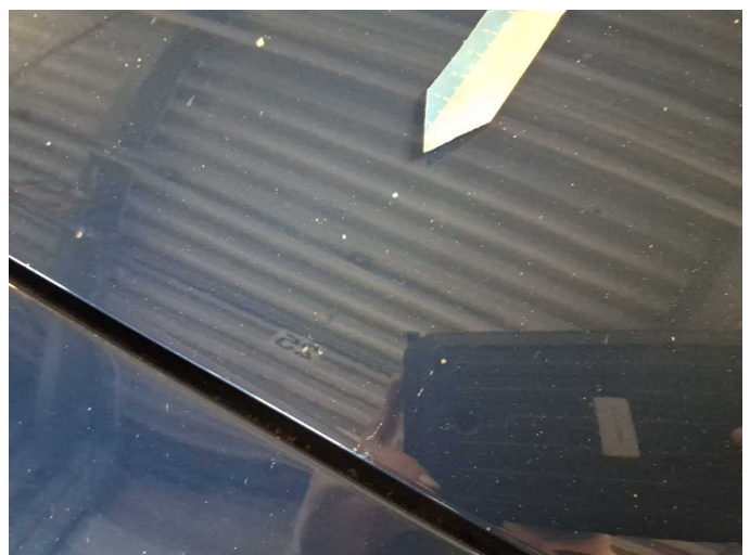
Damage 13: Bonnet: Bonnet (Sandstrahleffekt) - Stone chips - Paint
