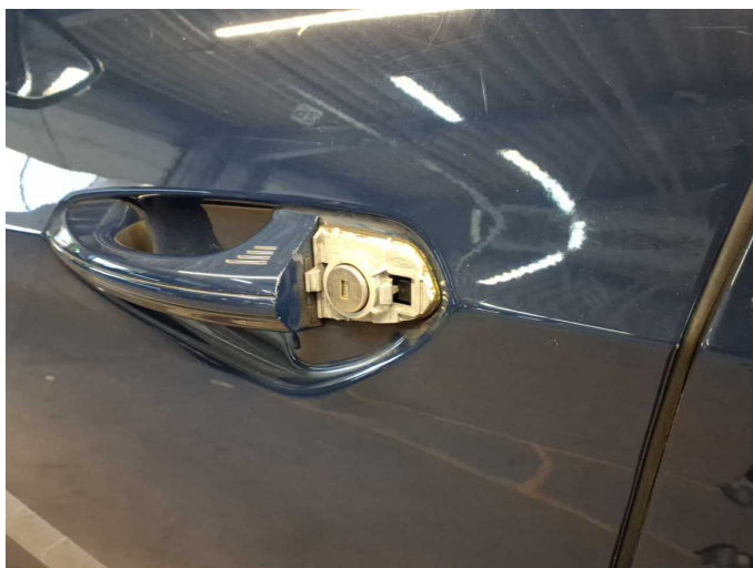
Damage 7: Door - front left side: Door handle - outside (Schlossabdeckung) - Missing - Replace
