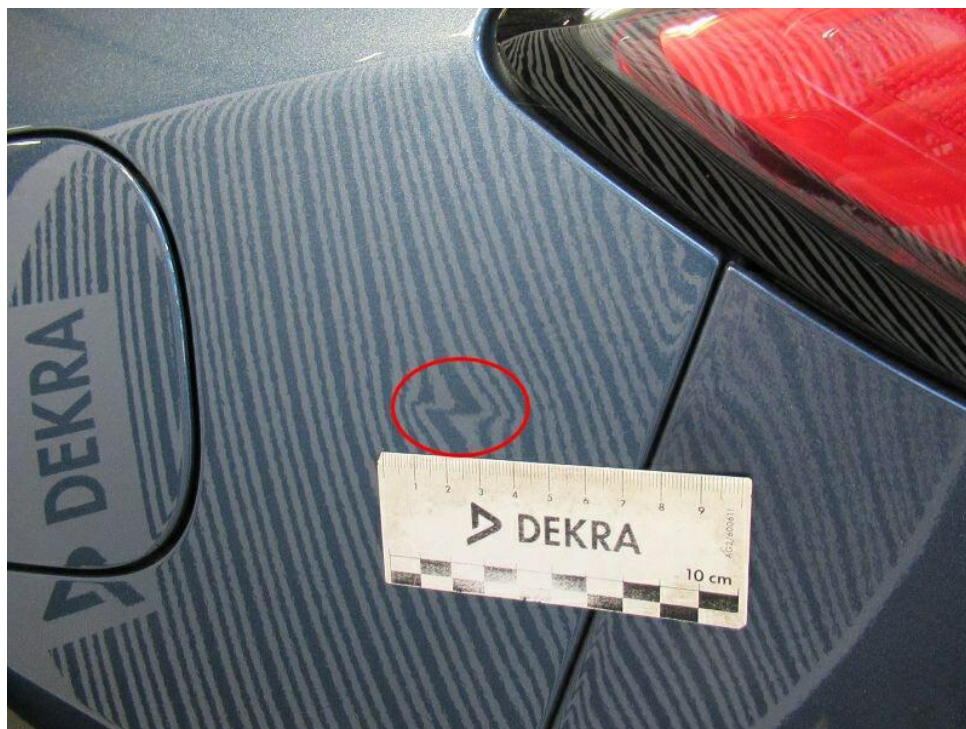
Bild 8 : Seitenteil hinten links, eingedellt, smart repair
