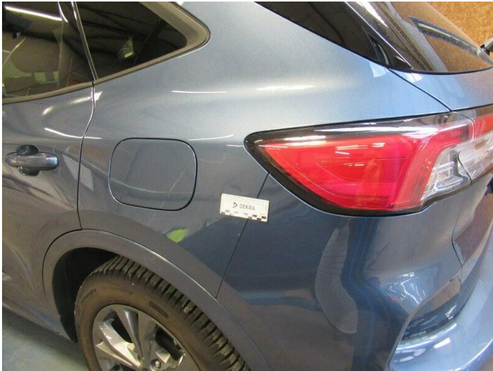
Bild 9 : Seitenteil hinten links, eingedellt, smart repair
