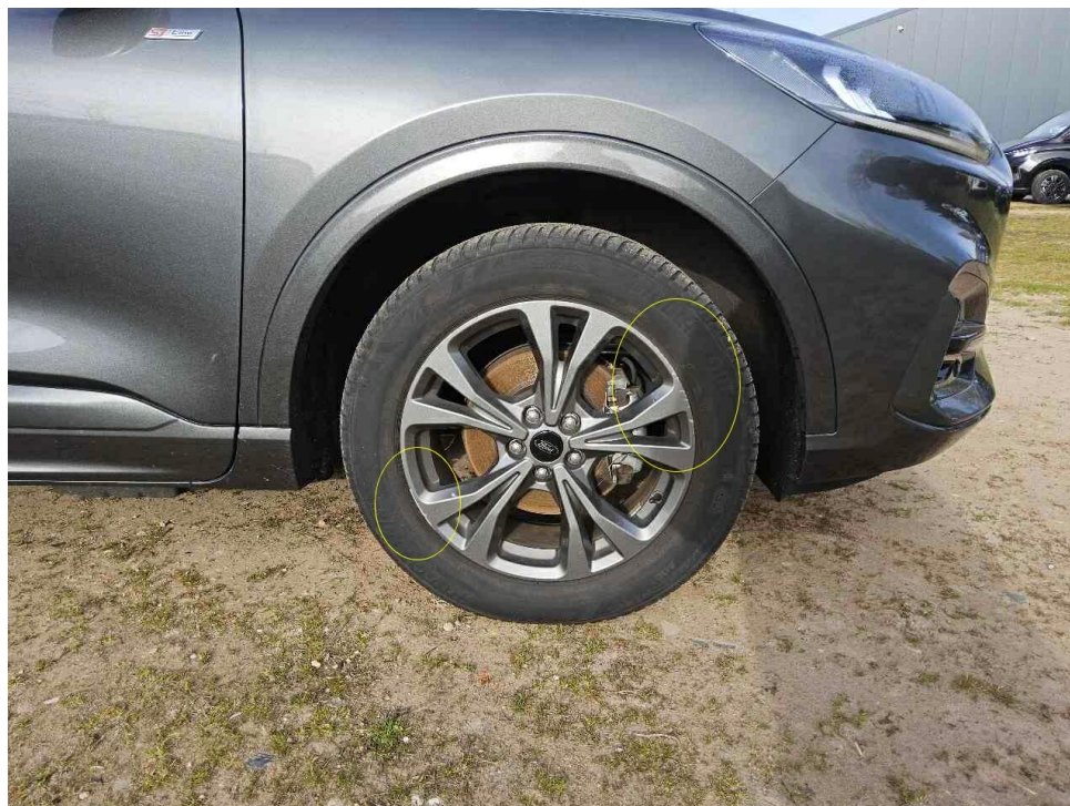
Bild 6 : Schadenübersicht rechte vordere Felge mehrfach beschädigt
