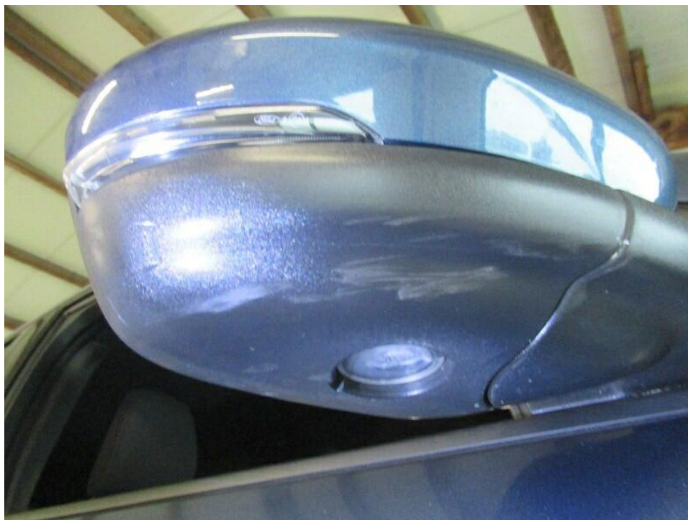
Bild 15 : Außenspiegel rechts Gehäuse, zerkratzt, Gebrauchsspur
