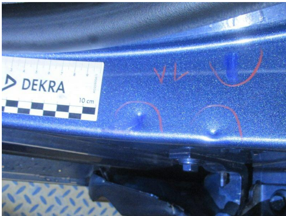
Bild 11 : Tür vorne links Einstieg, mehrfach eingedellt, smart repair
