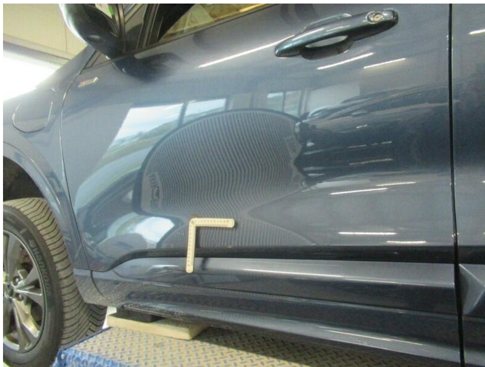
Bild 17 : Tür vorne links, eingedellt, smart repair
