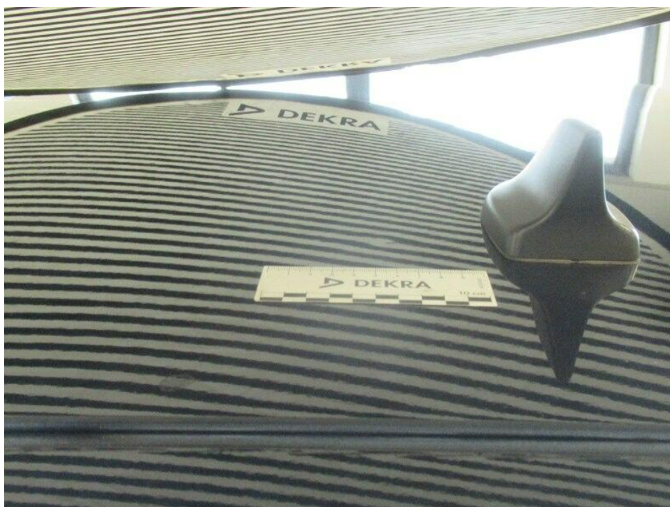
Bild 12 : Dach, mehrfach eingedellt, smart repair
