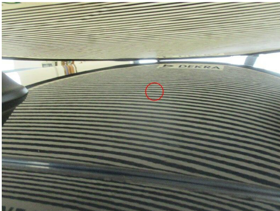
Bild 13 : Dach, mehrfach eingedellt, smart repair
