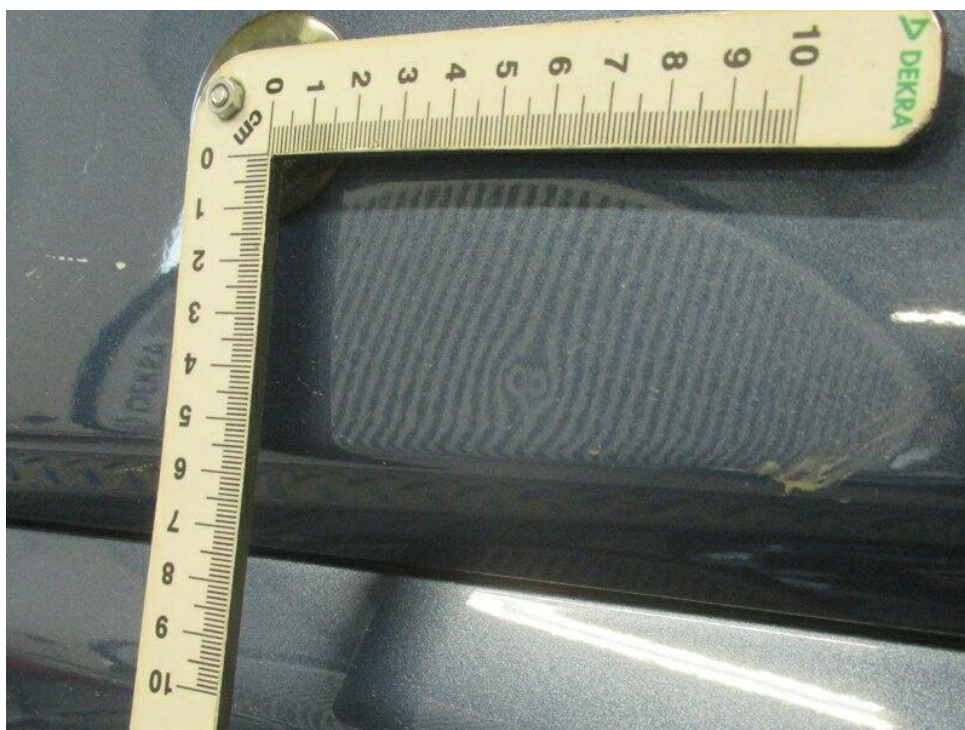
Bild 18 : Tür vorne links, eingedellt, smart repair
