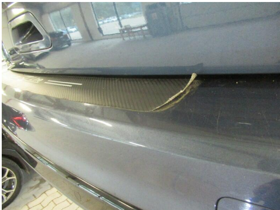
Bild 16 : Stoßfänger hinten Schutzfolie, löst sich, entfernen
