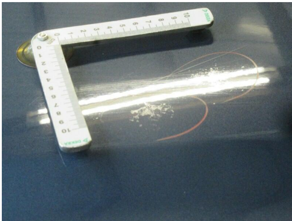
Bild 9 : Motorhaube Lackierung, Umweltschaden, lackieren mit Lackaufbau
