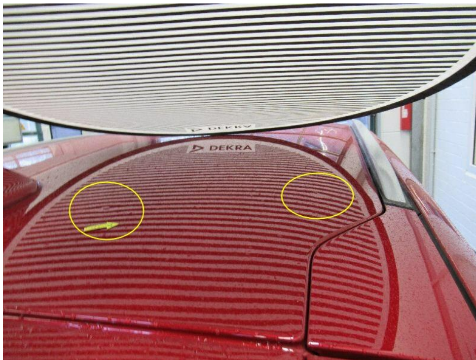
Bild 25 : Dach, mehrfach eingedellt, drücken
