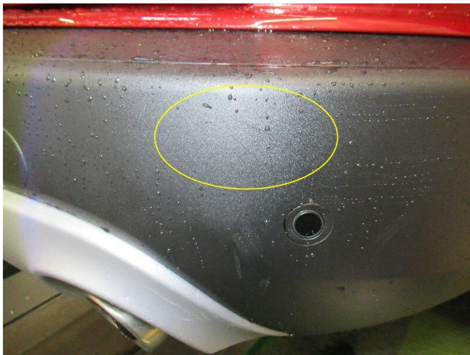
Bild 15 : Stoßfänger hinten, verschrammt, Gebrauchsspur
