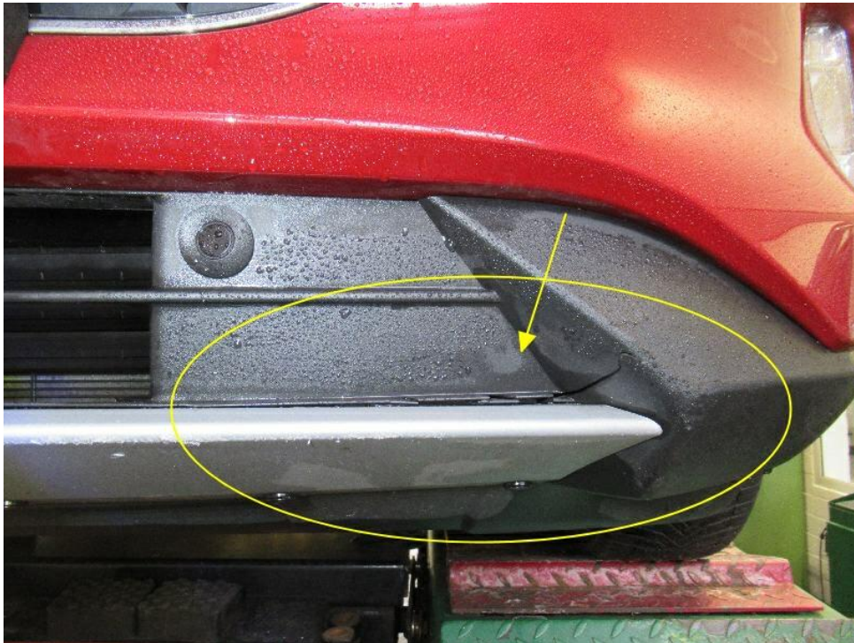
Bild 21 : Frontspoiler und Luftführung vorne zerkratzt und gerissen
