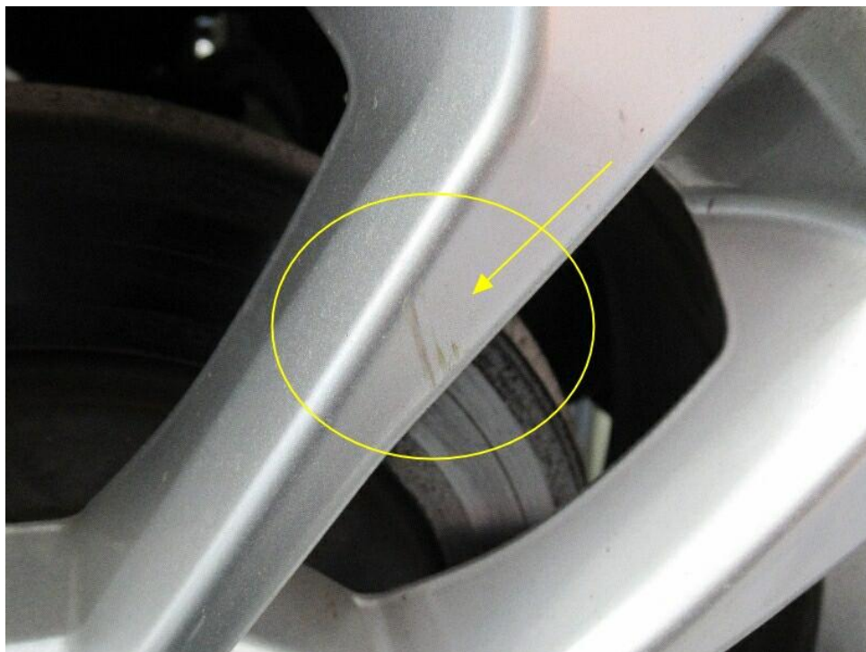
Bild 18 : Felge hinten rechts, verschrammt, Gebrauchsspur
