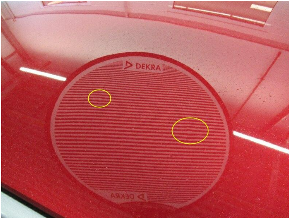
Bild 23 : Dach, mehrfach eingedellt, drücken
