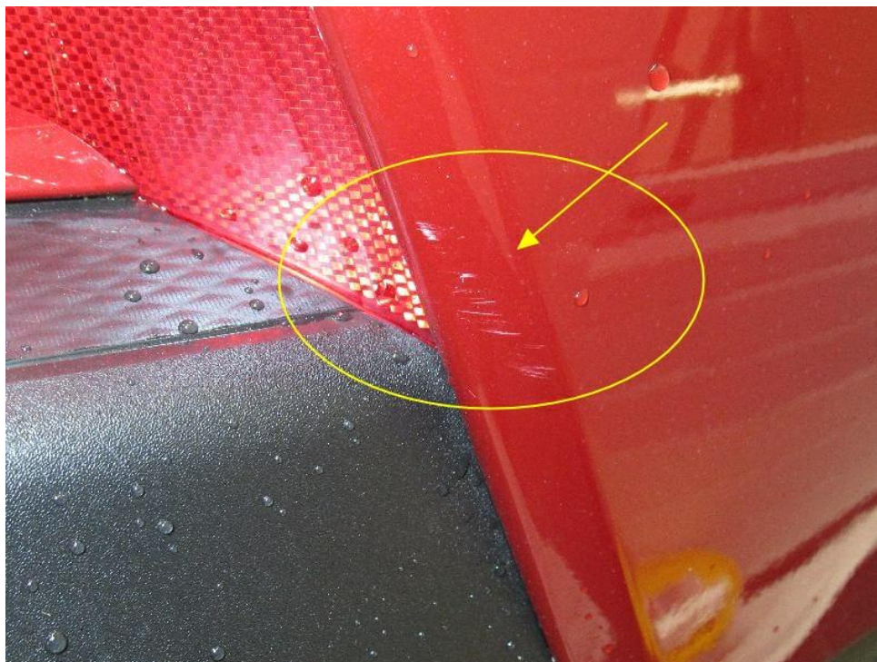
Bild 17 : Stoßfänger hinten Lackierung, zerkratzt, smart repair
