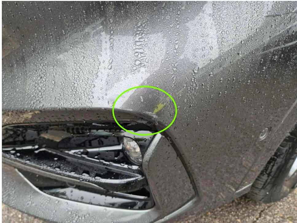
Bild 7 : Stoßfänger vorne Lackierung, zerkratzt, smart repair
