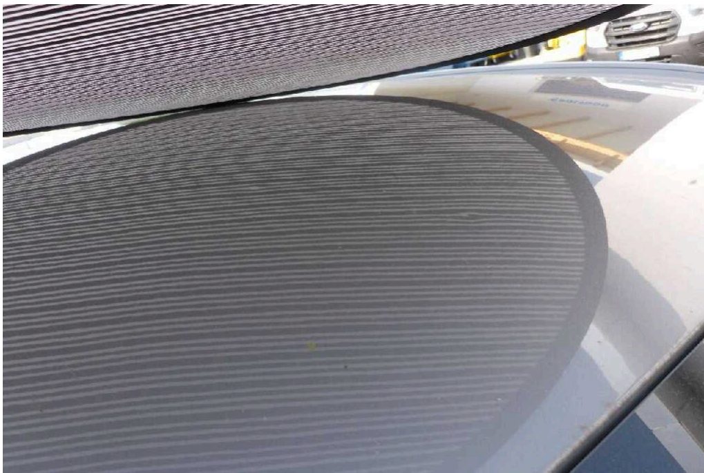
Bild 48 Fahrzeug 480 Dellen Dachbereich Hagelschaden Dellen
