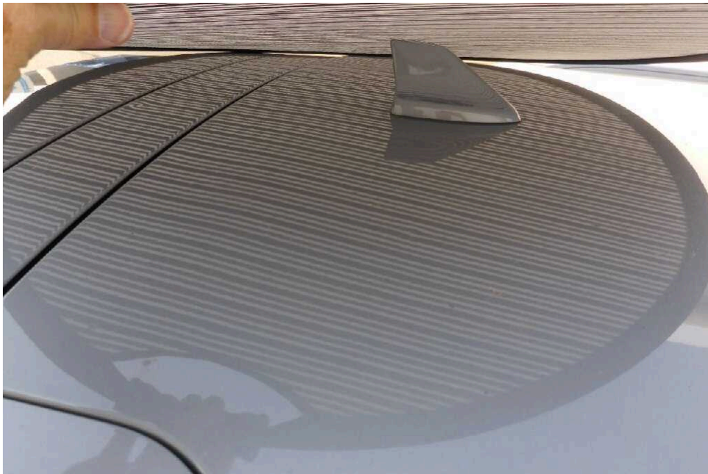
Bild 51 Fahrzeug 480 Dellen Dachbereich Hagelschaden Dellen
