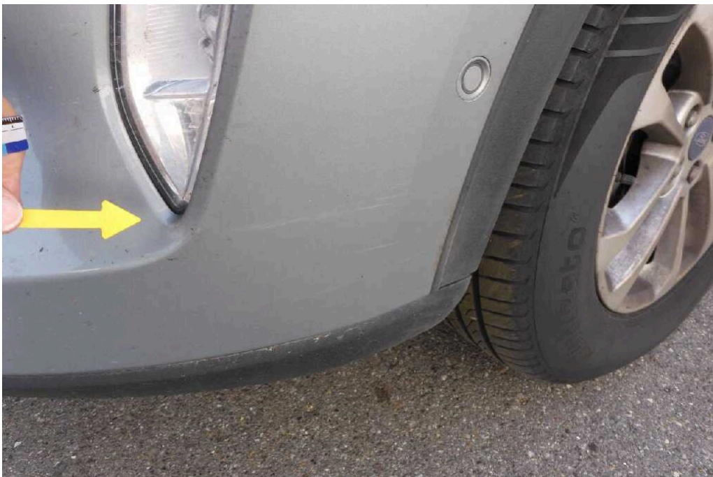
Bild 20 Fahrzeugfront Stoßfänger vorne verkratzt
