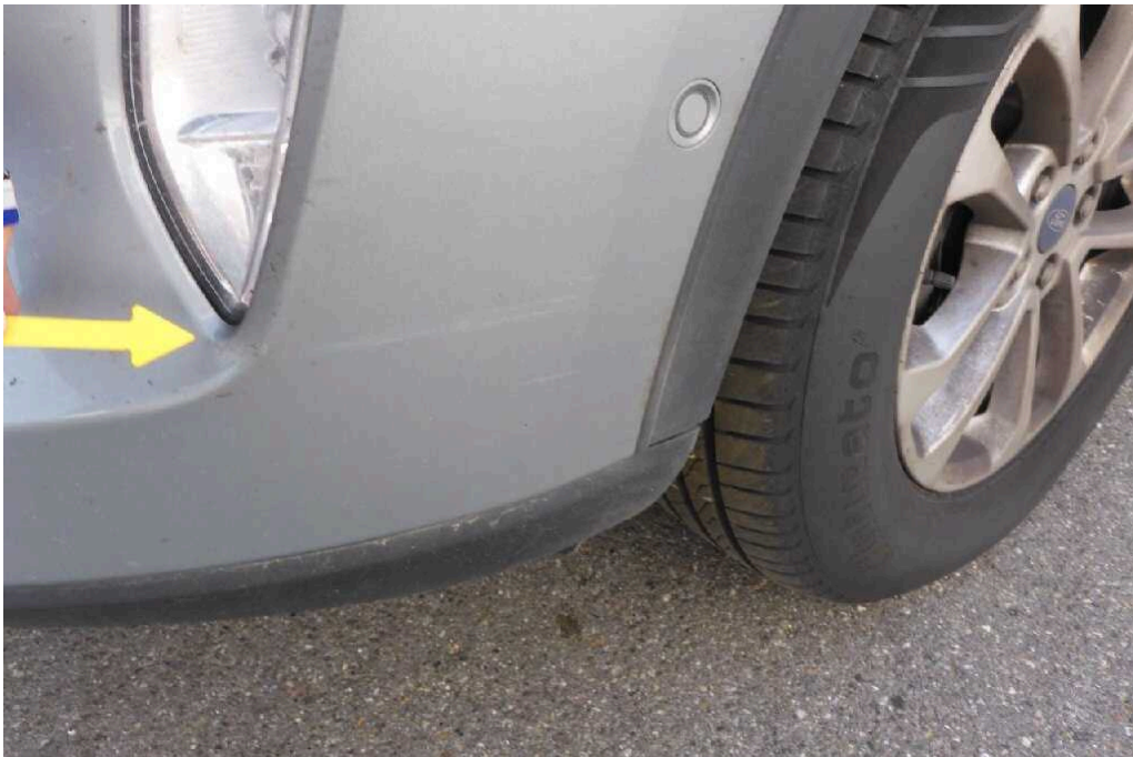
Bild 19 Fahrzeugfront Stoßfänger vorne verkratzt
