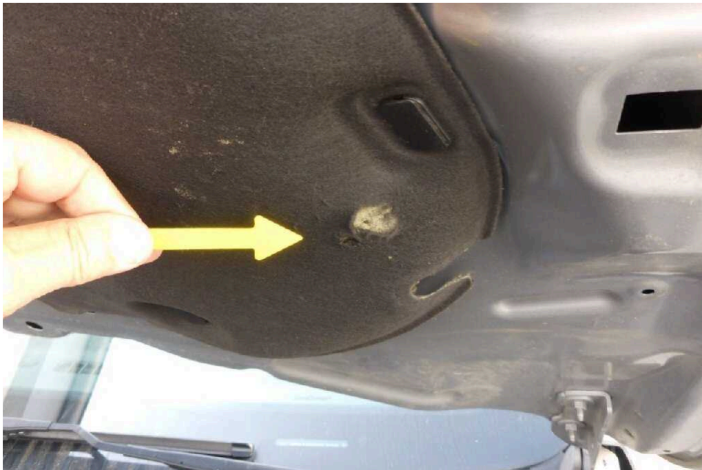
Bild 37 Motor Motorraum Dämmmatte beschädigt
