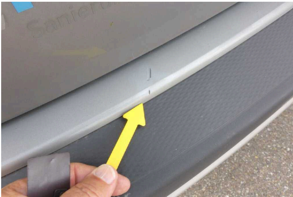
Bild 24 Fahrzeugheck Stoßfänger hinten deformiert
