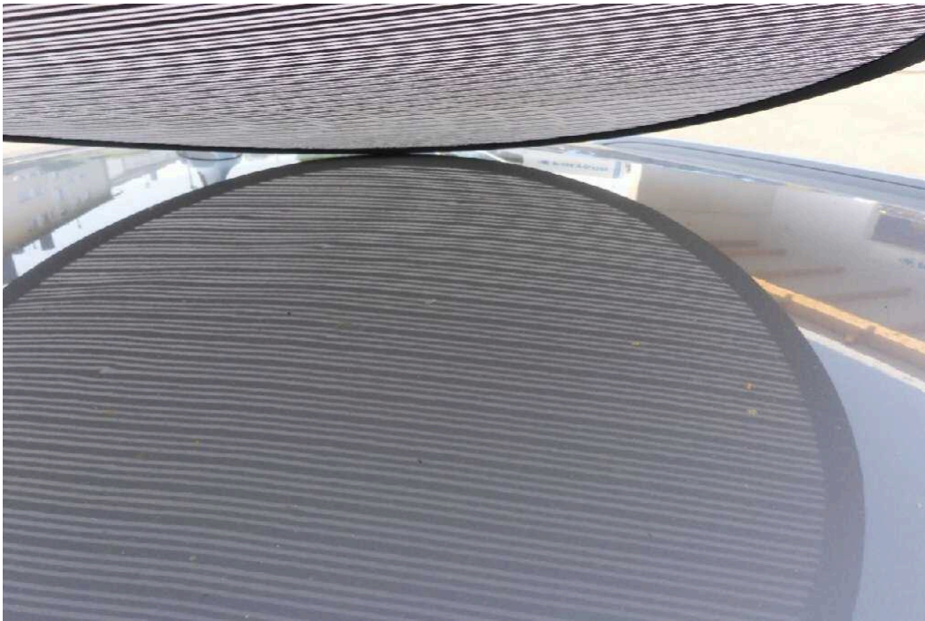
Bild 43 Fahrzeug 480 Dellen Dachbereich Hagelschaden Dellen
