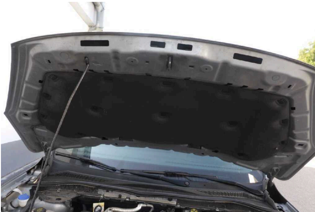
Bild 36 Motor Motorraum Dämmmatte beschädigt
