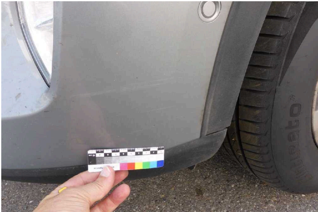
Bild 21 Fahrzeugfront Stoßfänger vorne verkratzt
