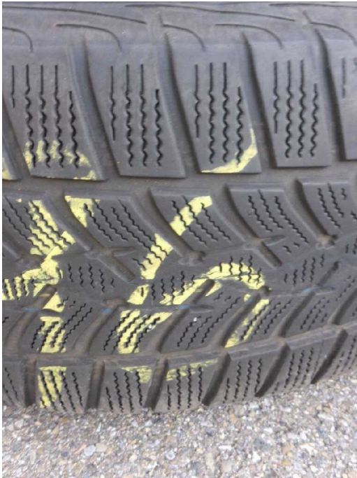
Bild 41 Fahrzeug Winterreifen 2x Verschleißgrenze erreicht
