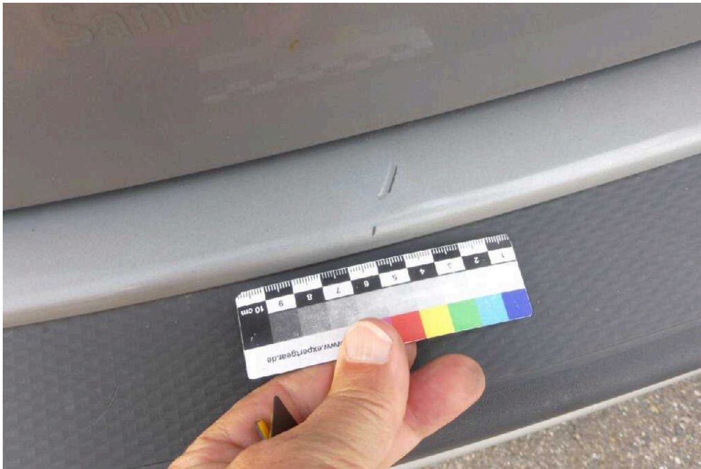
Bild 23 Fahrzeugheck Stoßfänger hinten deformiert
