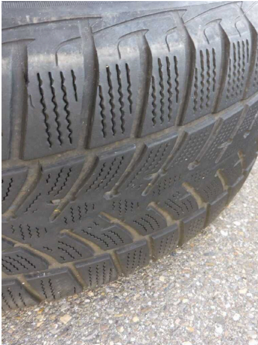
Bild 39 Fahrzeug Winterreifen 2x Verschleißgrenze erreicht
