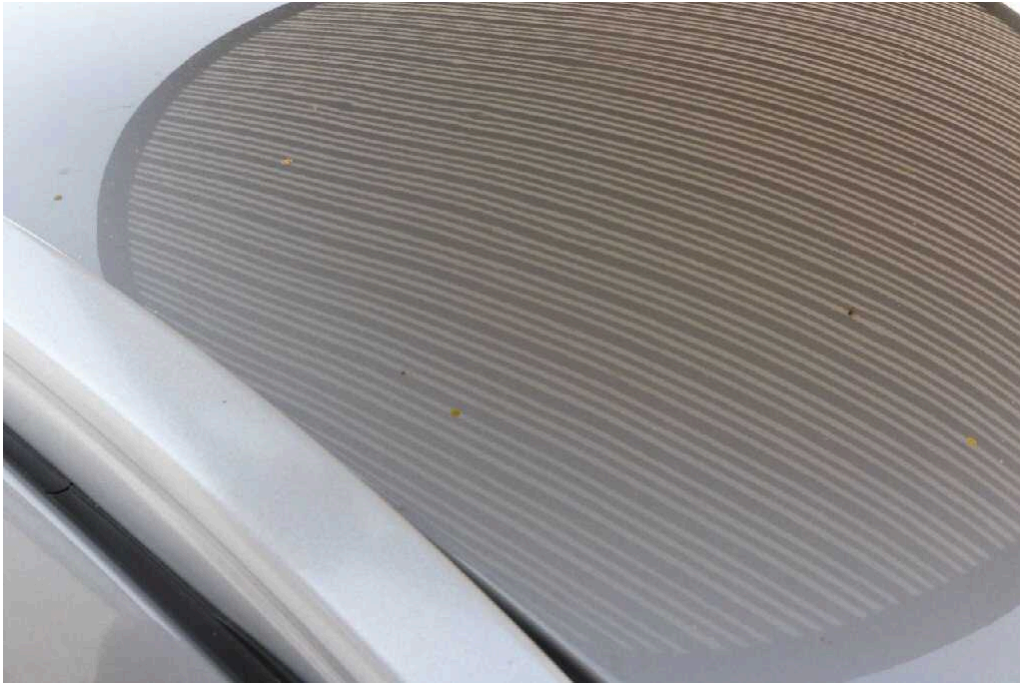
Bild 49 Fahrzeug 480 Dellen Dachbereich Hagelschaden Dellen
