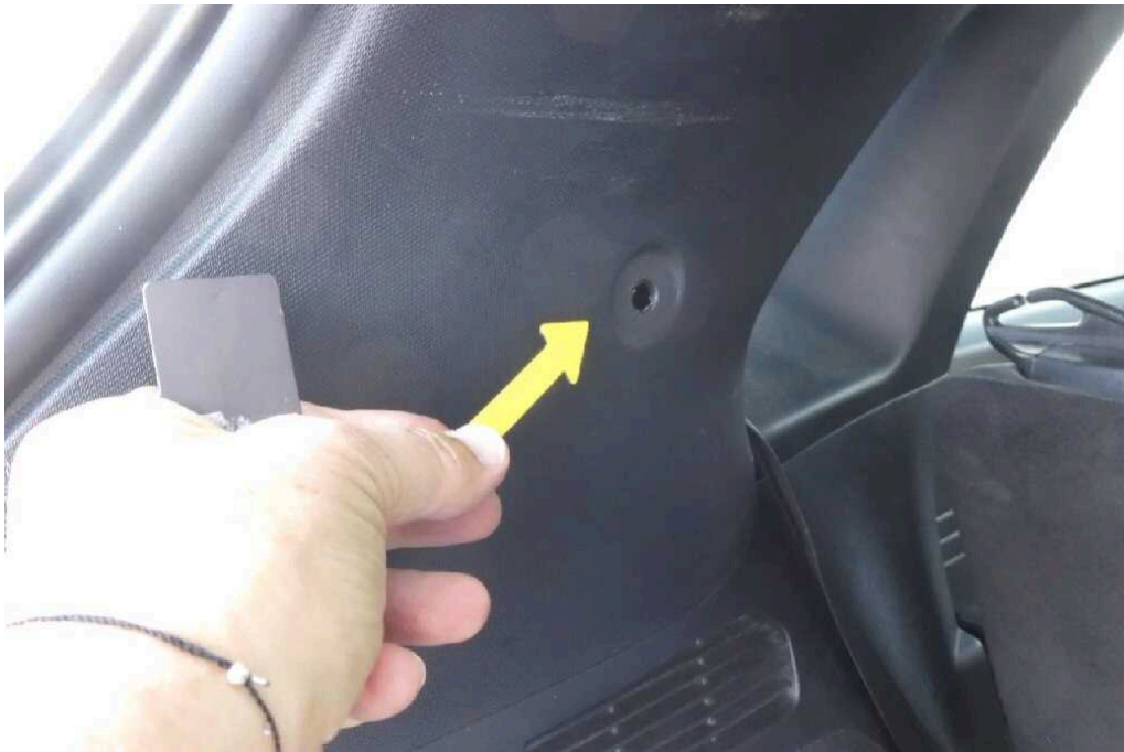
Bild 27 Innenraum C-Säulen Verkleidung links beschädigt
