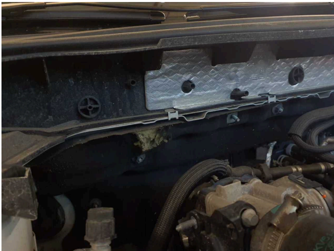
Damage 5: Engine: Engine cover - top / cover (+maderschaden, Folgekosten sind möglich) - Damaged - Replace
