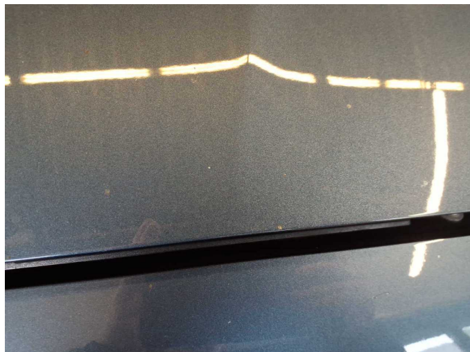
Damage 8: Bonnet: Bonnet (Vogelkotverätzung + Steinschläge) - Paint defect - Paint
