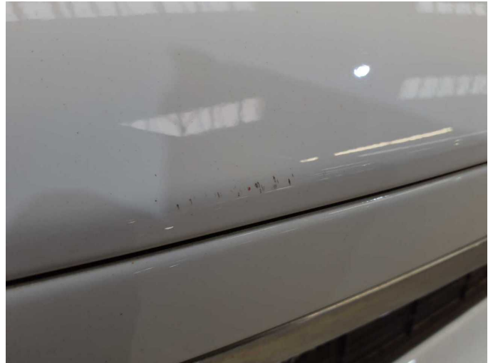
Damage 2: Boot lid / rear door: Boot lid - Scratch(es) - Paint
