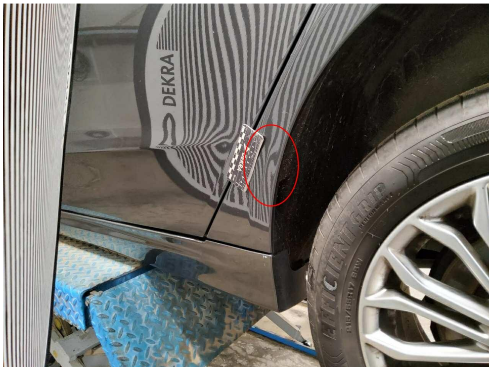
Bild 8 : Seitenteil hinten links, eingedellt, smart repair
