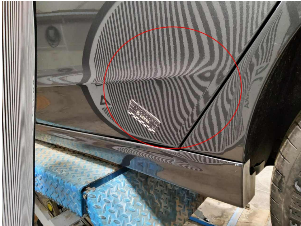
Bild 7 : Tür hinten links, deformiert, instandsetzen und lackieren mit Lackaufbau
