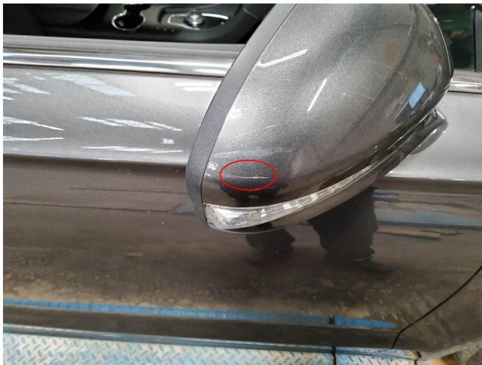
Bild 14 : Außenspiegel rechts zerkratzt
