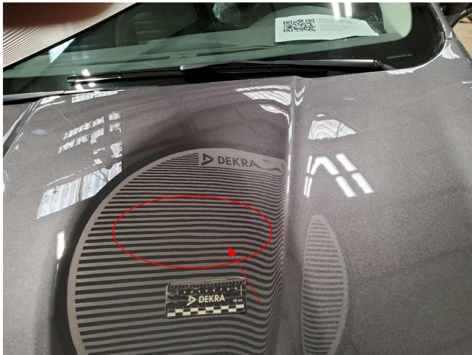
Bild 9 : Motorhaube Lackierung, nicht fachgerecht, wellig, lackieren mit Lackaufbau
