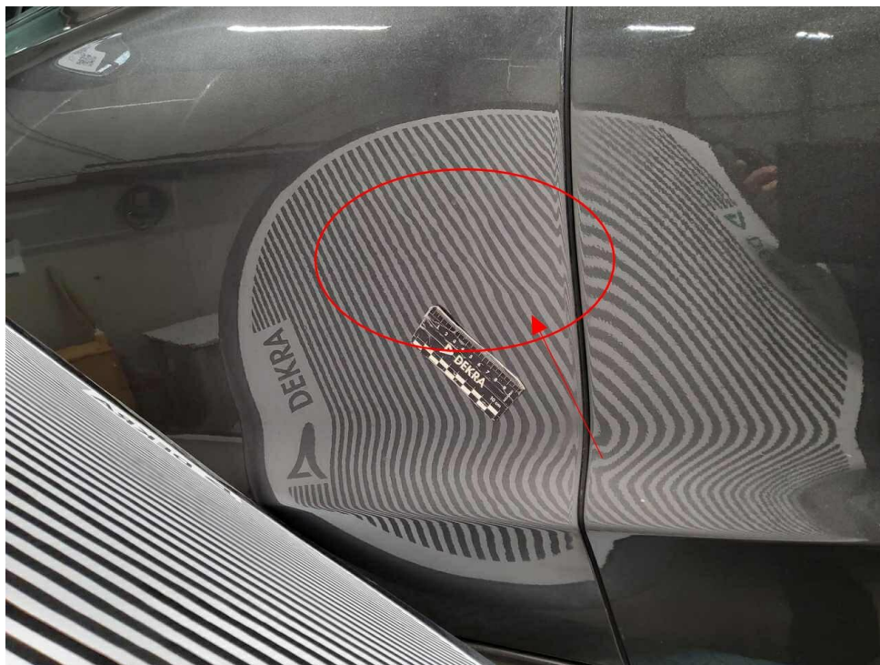
Bild 6 : Tür vorne links, nicht fachgerecht, wellig , lackieren mit Lackaufbau
