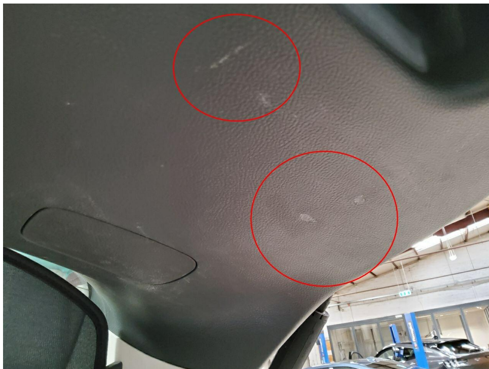
Bild 13 : Heckklappen Verkleidung verschrammt
