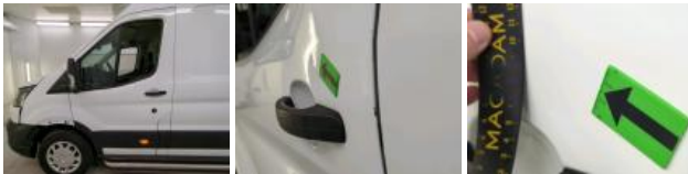
Zijwand A L (Bedr.w), Kras(sen), Herstellen en spuiten (compleet)
