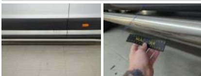
Zijwand A R (Bedr.w), Deuk(en) en kras(sen), Herstellen en spuiten (compleet)
