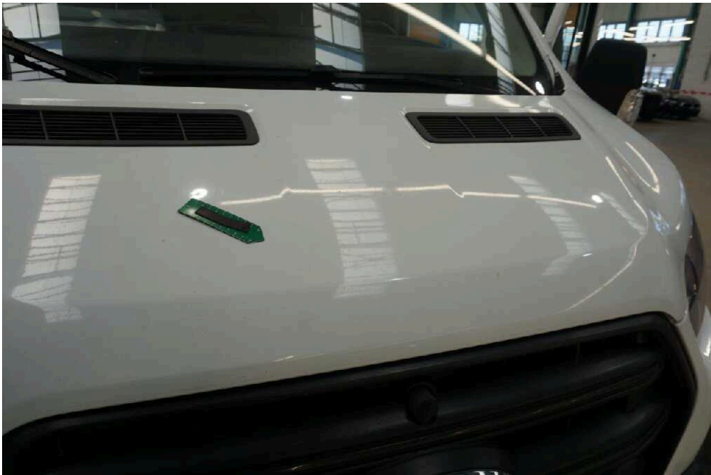
Bild 20 Fahrzeugfront Motorhaube Steinschlag / -schläge
