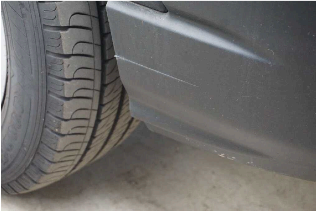
Bild 19 Fahrzeugfront Stoßfänger vorne verkratzt
