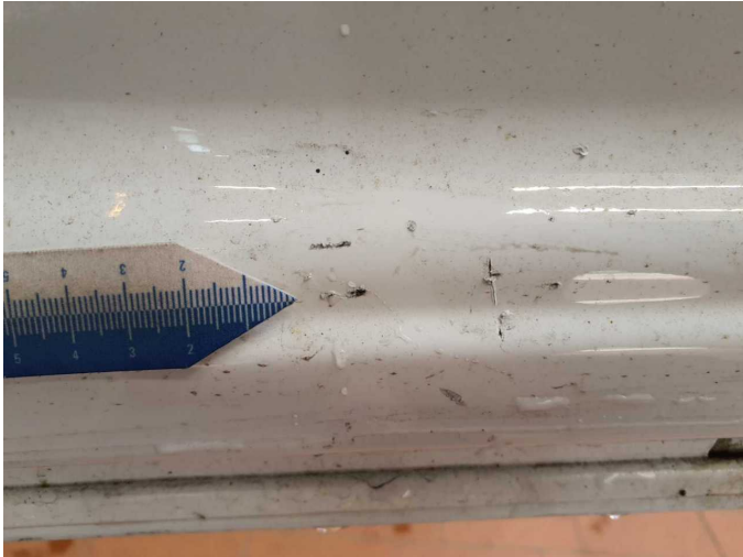
Damage 9: Boot lid / rear door: Rear door - right side (verschließen, lackieren) - Holes - Repair and paint
