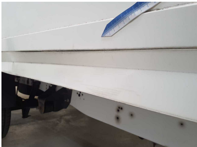
Damage 12: Side panel - rear right side: Side panel (Kofferaufbau unten, Unterzug) - Deformed - Replace
