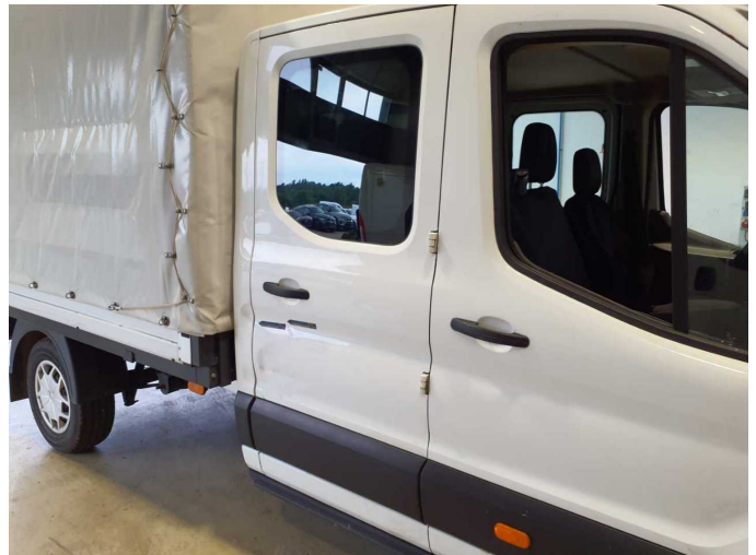
Damage 8: Door - rear right side: Door (Außenblech) - Deformed - Replace
