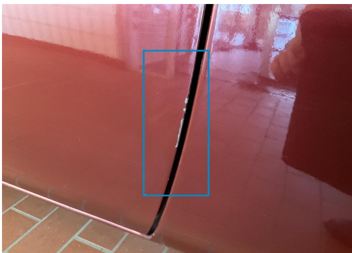
17. Door / Front Left Paint / Chipping -
