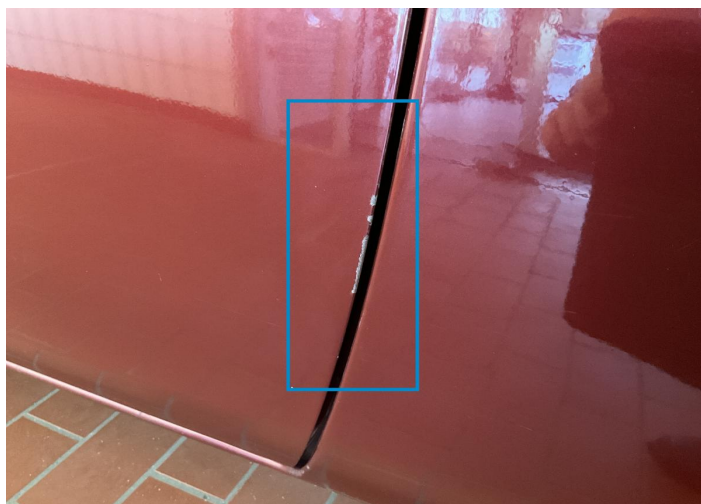
17. Door / Front Left Paint / Chipping -
