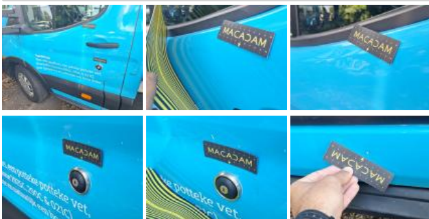
Sill trim L, Scratch(es), Replace
