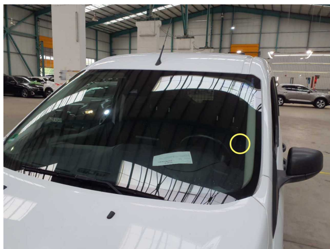
Damage 5: Vehicle glazing: Windscreen (Mit Rissbildung) - Stone chips - Replace
