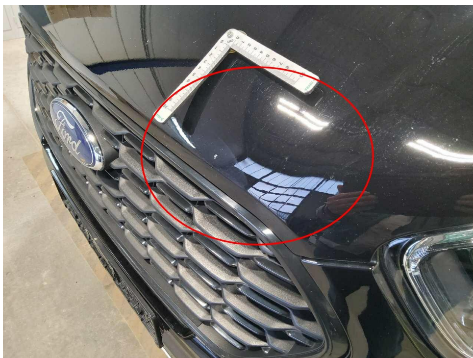
Bild 8 : Motorhaube Lackierung, viele Steinschläge, lackieren
