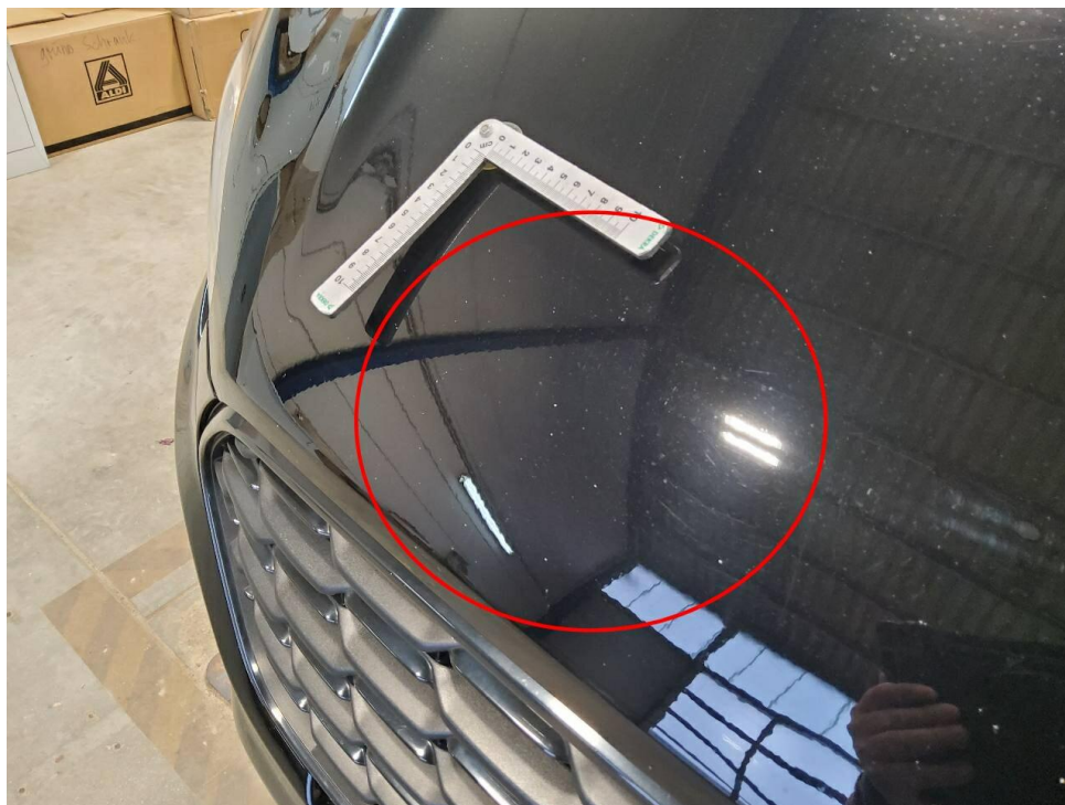
Bild 7 : Motorhaube Lackierung, viele Steinschläge, lackieren
