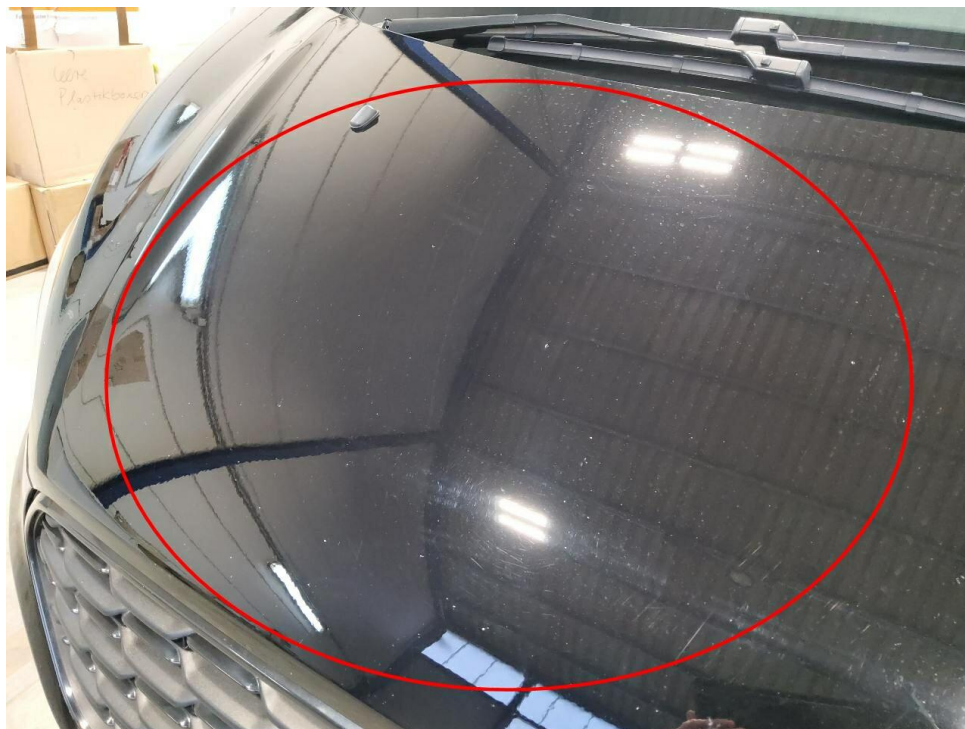
Bild 9 : Motorhaube Lackierung, viele Steinschläge, lackieren
