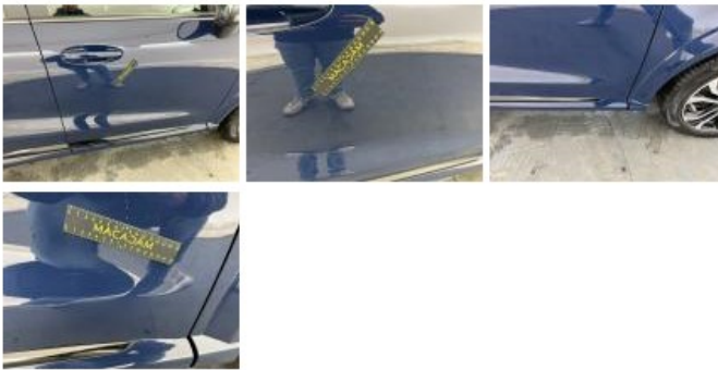
Wielkuip bekleding V R, Kras(sen), Vervangen
