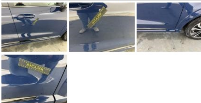
Wielkuip bekleding V R, Kras(sen), Vervangen
