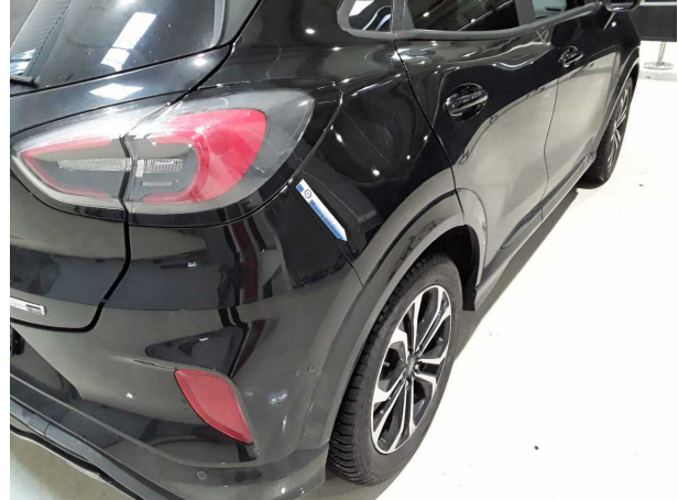
Beschädigung #11: Karosserie: Karosserie (Unfallschaden nicht fachgerecht Instandgesetzt) - abweichend
