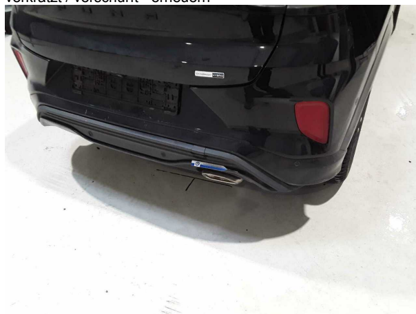
Beschädigung #8: Stossfänger hinten: Spoiler - verformt - erneuern
