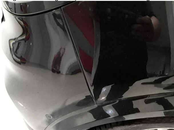
Beschädigung #11: Karosserie: Karosserie (Unfallschaden nicht fachgerecht Instandgesetzt) - abweichend Auslieferungszustand -
