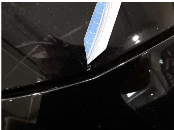
Beschädigung #9: Motorhaube: Motorhaube - Korrosion - lackieren
