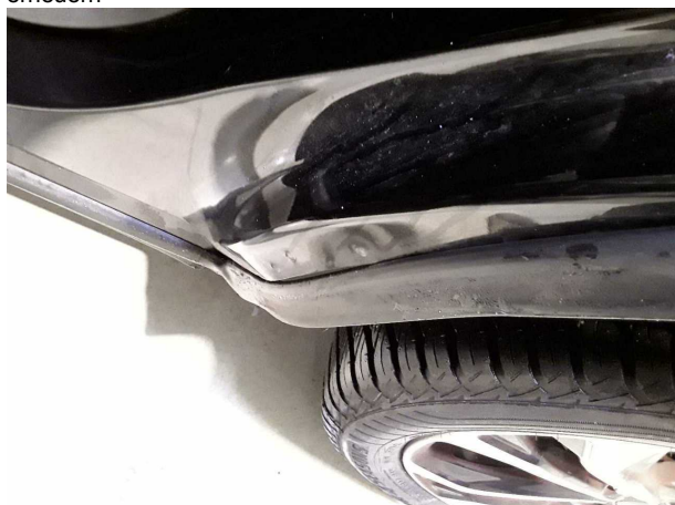
Beschädigung #3: Tür hinten links: Türdichtung - Fehlstellung - instandsetzen
