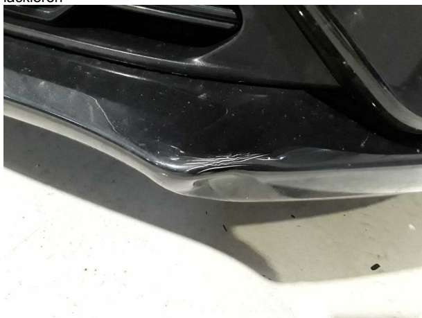
Beschädigung #10: Stossfänger vorn: Spoiler - verformt - erneuern
