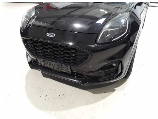
Beschädigung #10: Stossfänger vorn: Spoiler - verformt - erneuern
