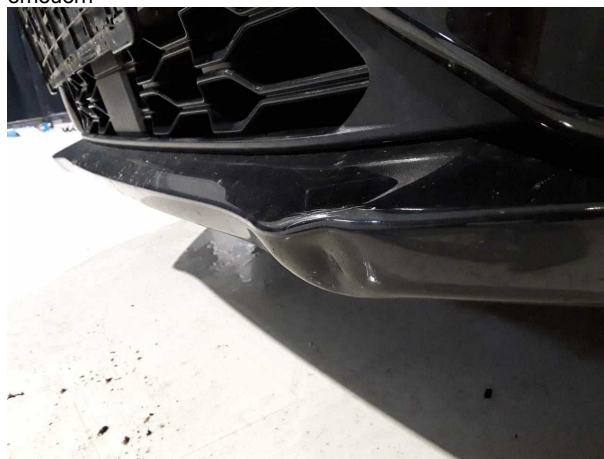
Beschädigung #10: Stossfänger vorn: Spoiler - verformt - erneuern
