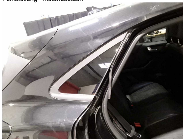
Beschädigung #5: Tür hinten rechts: Türdichtung (Eckfenster) - gebrochen / gerissen - erneuern
