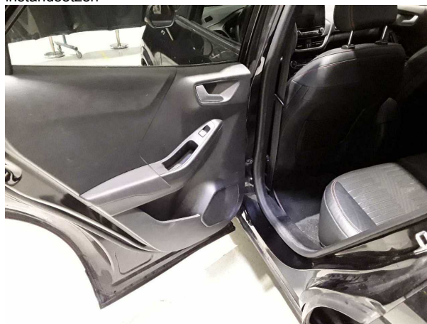
Beschädigung #4: Tür hinten links: Tür (Türfangband lose) - Fehlstellung - instandsetzen
