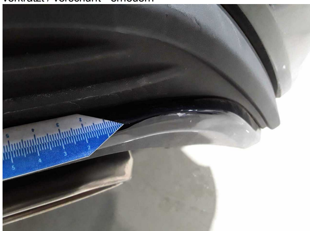
Beschädigung #8: Stossfänger hinten: Spoiler - verformt - erneuern
