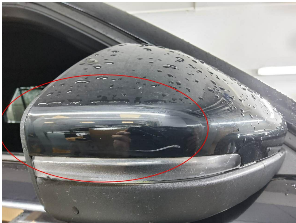
Bild 15 : Spiegelkappe rechts - zerkratzt
