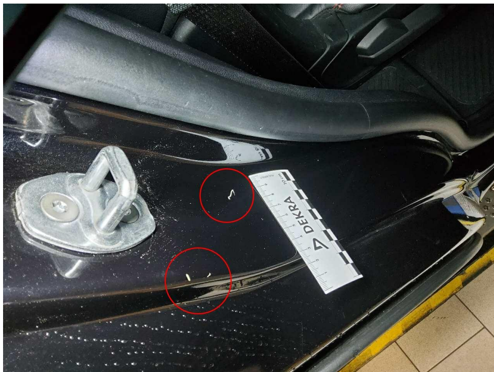
Bild 7 : Einstieg hinten rechts - zerkratzt
