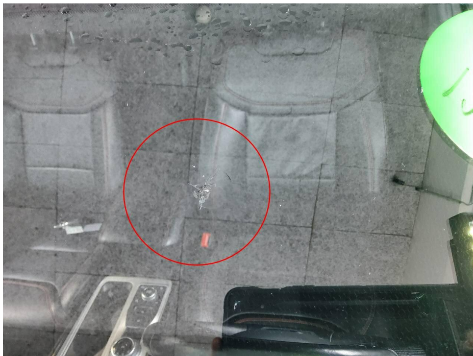
Bild 13 : Windschutzscheibe- Steinschlag mit Rissbildung
