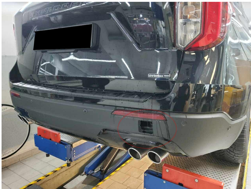
Bild 16 : Stoßfänger hinten- Abdeckkappe für Abschleppöse fehlt
