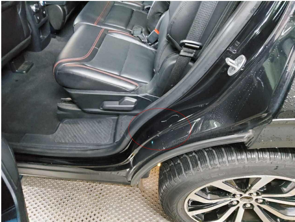
Bild 8 : Einstieg hinten links- zerkratzt
