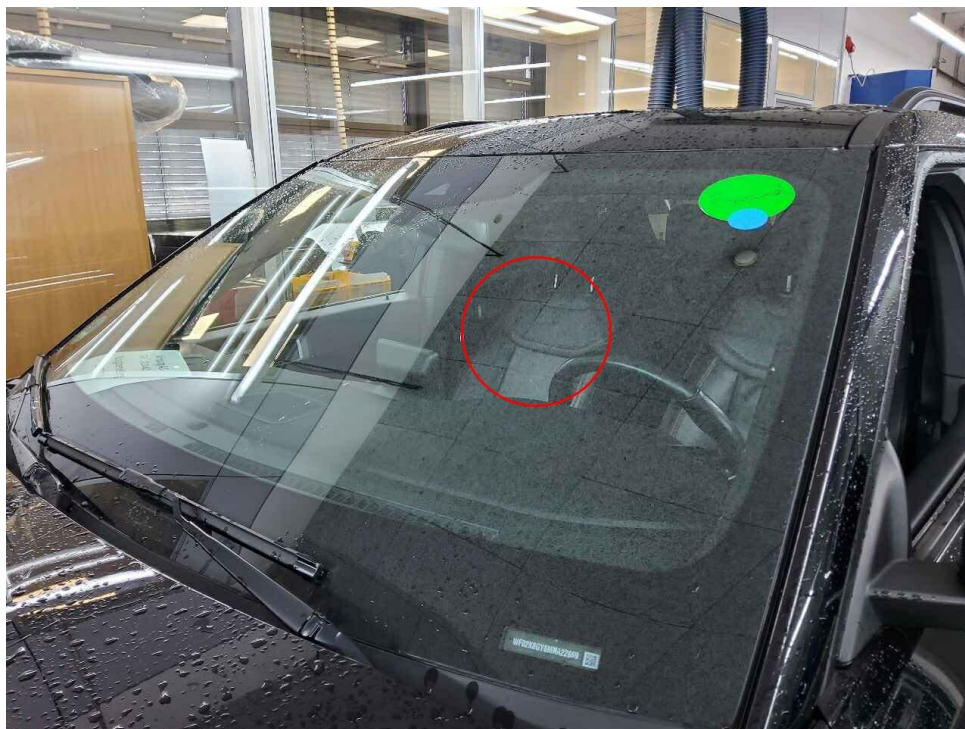
Bild 12 : Windschutzscheibe- Steinschlag mit Rissbildung
