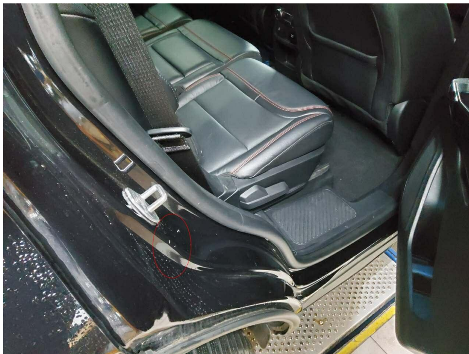
Bild 6 : Einstieg hinten rechts - zerkratzt
