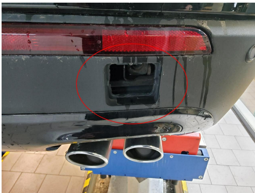
Bild 17 : Stoßfänger hinten- Abdeckkappe für Abschleppöse fehlt
