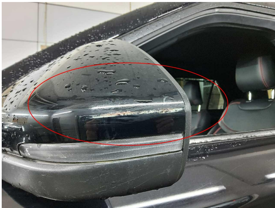
Bild 14 : Spiegelkappe links - zerkratzt
