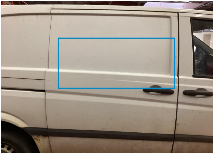
30. Door / Back Right Paint / Chipping -
