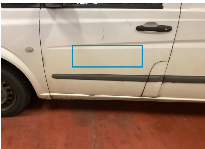
12. Door / Front Left Paint / Chipping -
