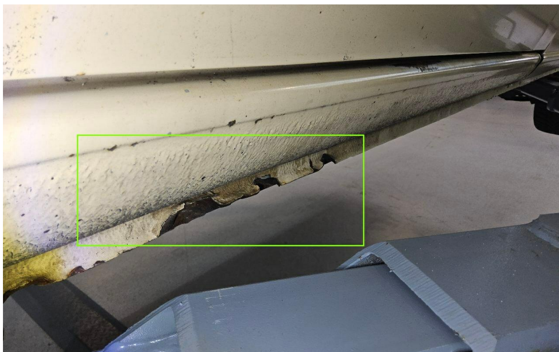
Bild 47 : Schweller links deformiert
