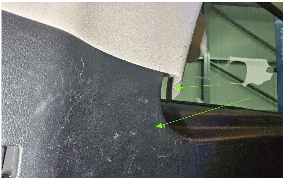
Bild 19 : Dachhimmel dreckig und gerissen
