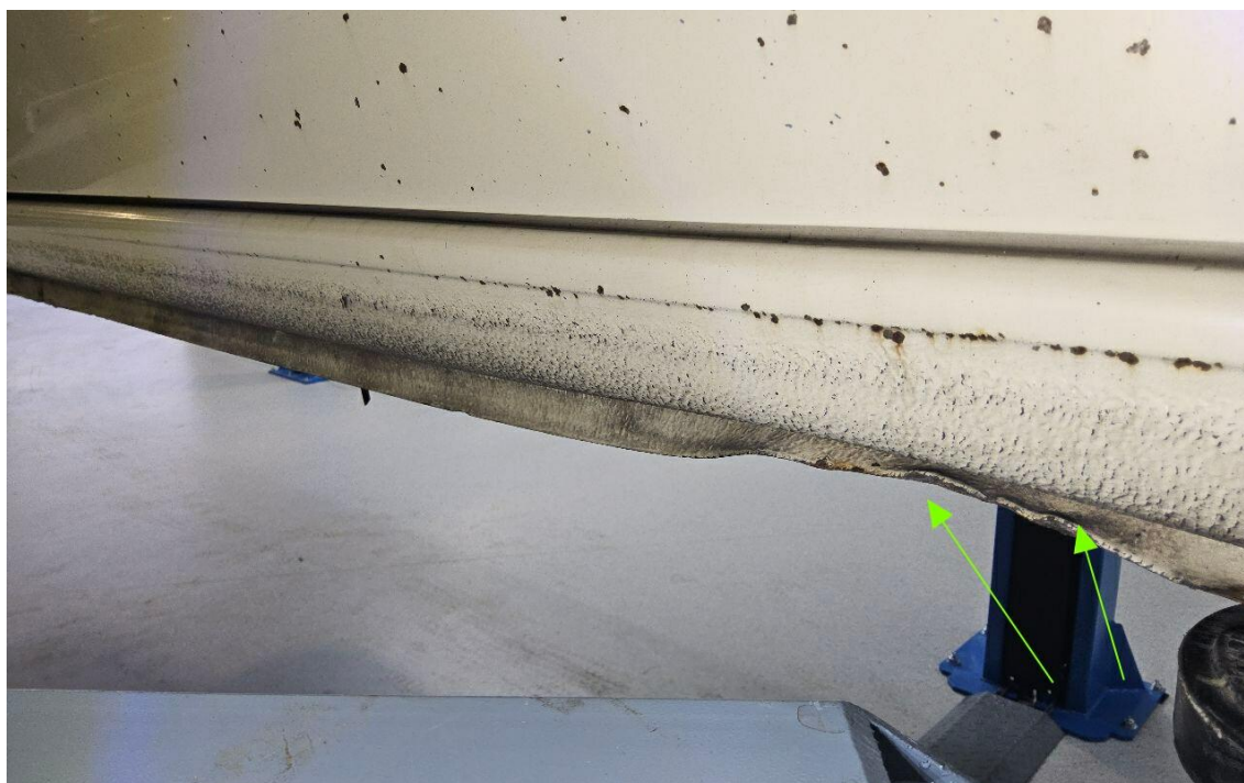
Bild 37 : Streifschaden rechte Seite
