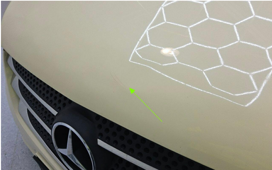
Bild 30 : Motorhaube Steinschläge und deformiert
