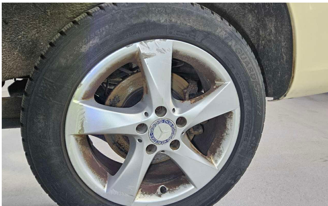
Bild 45 : Felge hinten links zerkratzt
