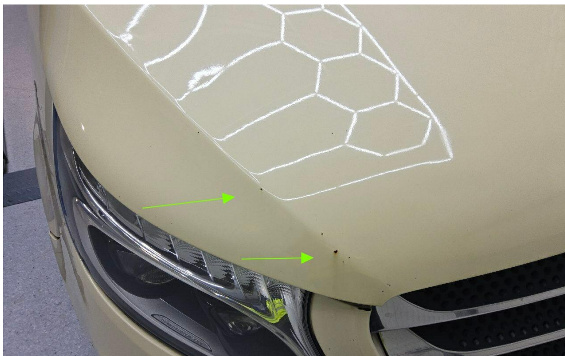
Bild 29 : Motorhaube Steinschläge und deformiert
