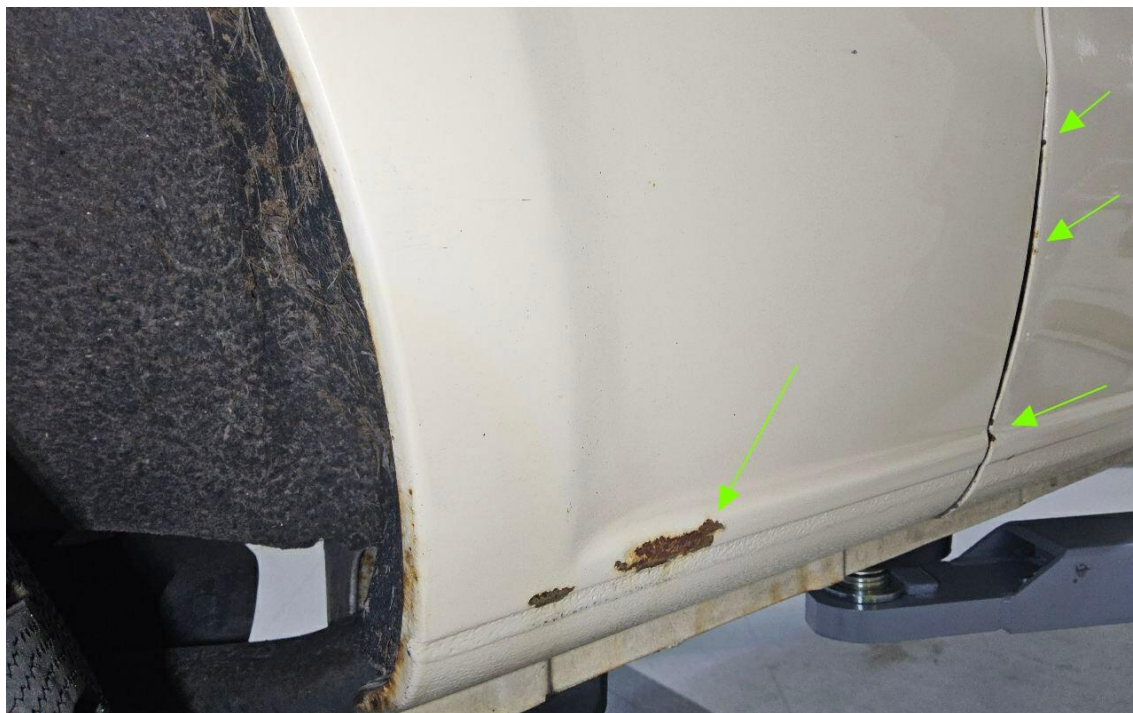
Bild 40 : Streifschaden rechte Seite
