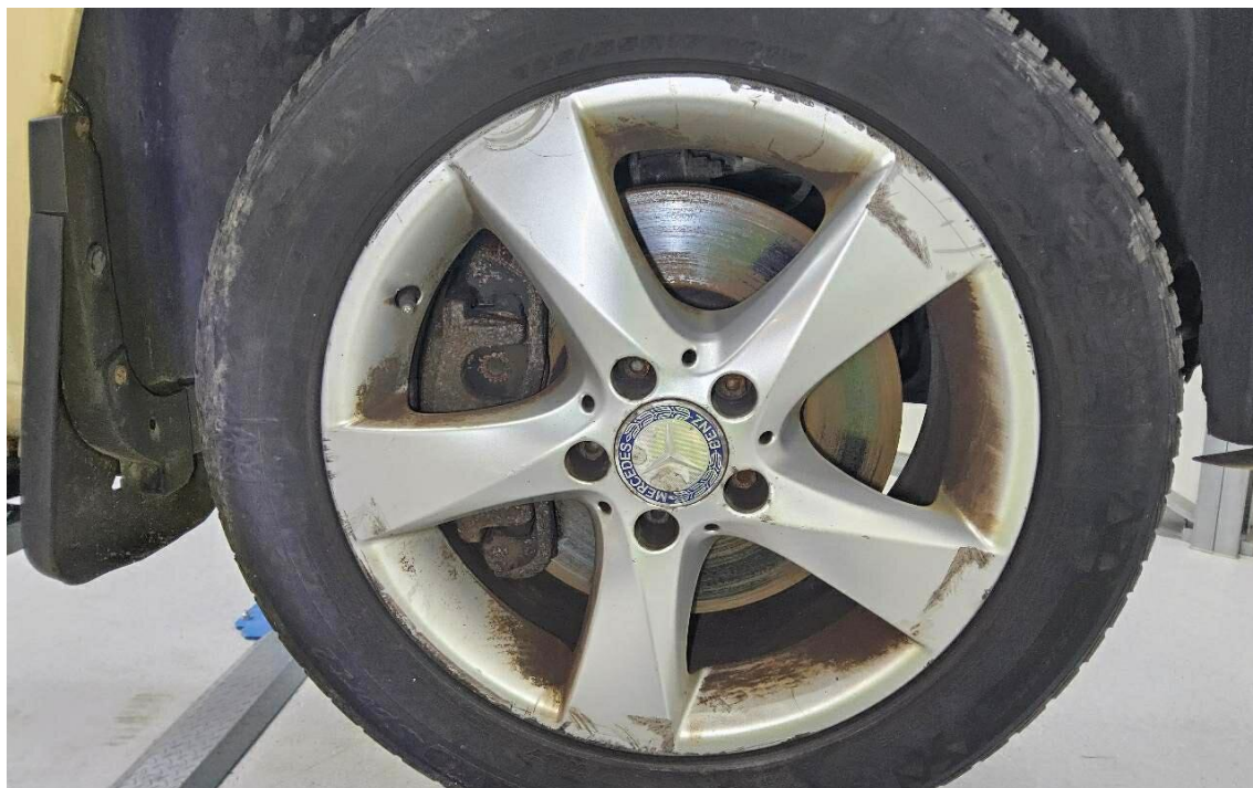
Bild 34 : Felge vorne rechts Materialabtrag
