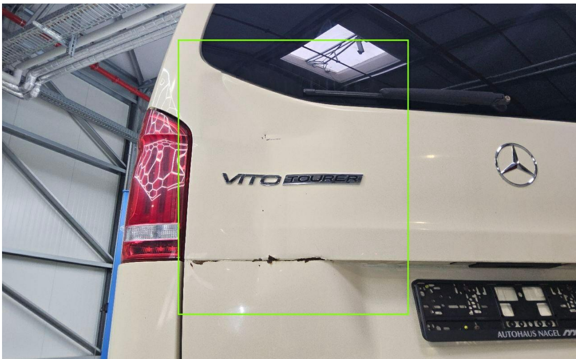
Bild 43 : Heckklappe links deformiert
