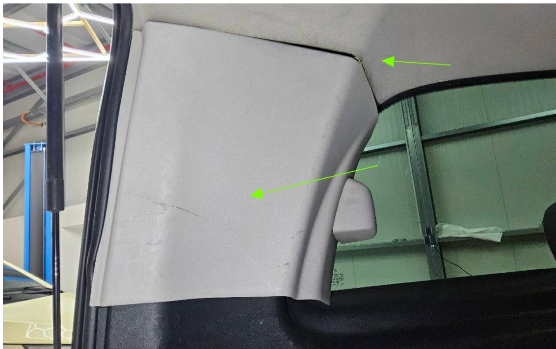
Bild 18 : Dachhimmel dreckig und gerissen
