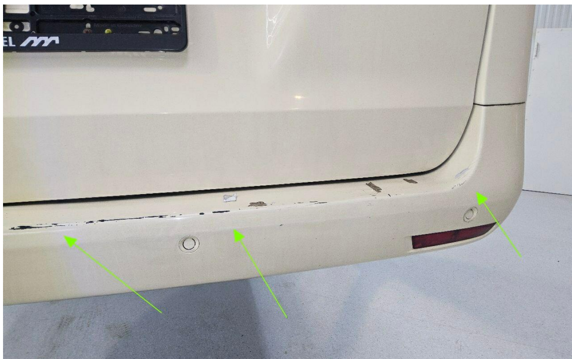
Bild 41 : Stoßfänger hinten deformiert
