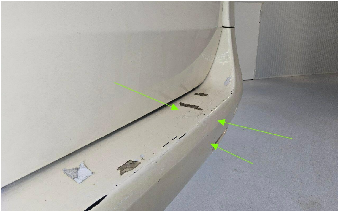
Bild 42 : Stoßfänger hinten deformiert
