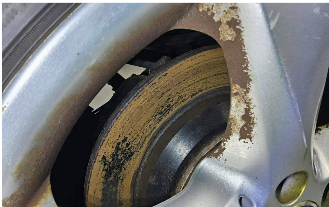
Bild 33 : Bremse stark korrodiert
