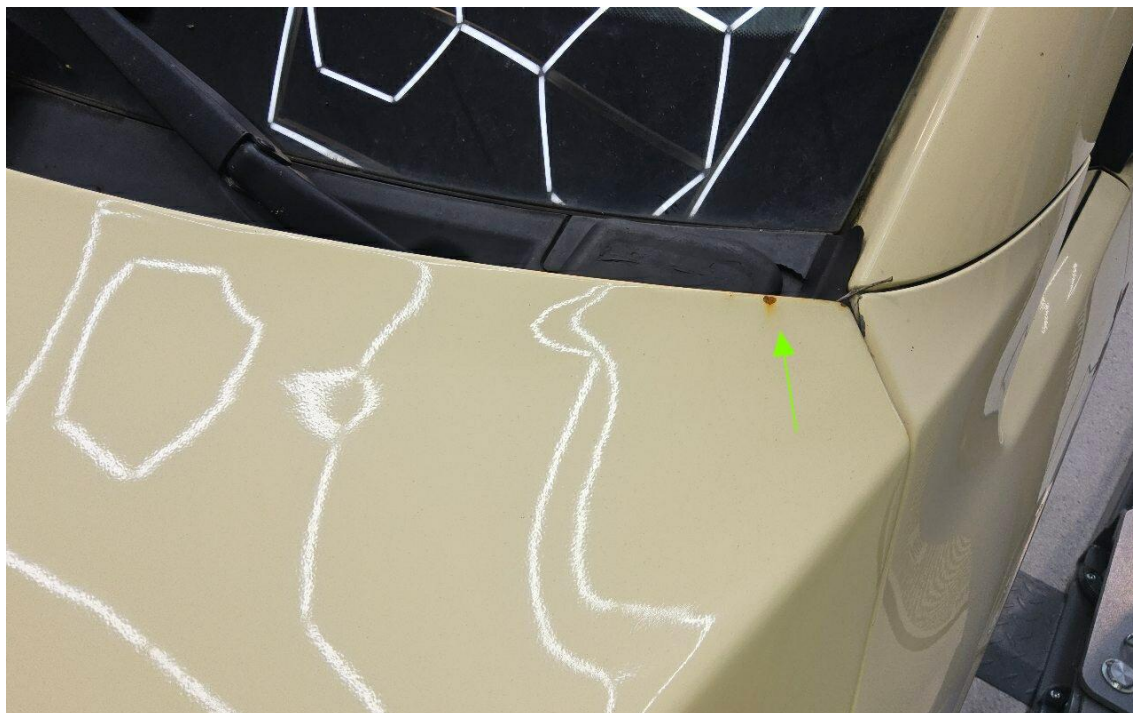
Bild 28 : Motorhaube Steinschläge und deformiert
