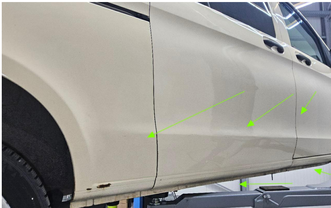
Bild 38 : Streifschaden rechte Seite
