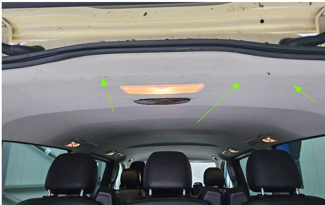
Bild 16 : Dachhimmel dreckig und gerissen
