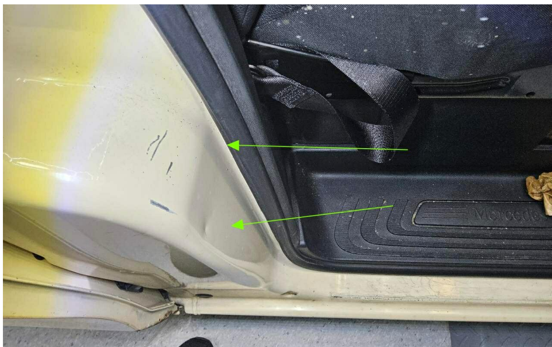
Bild 11 : Türeinstiege eingedellt und zerkratzt
