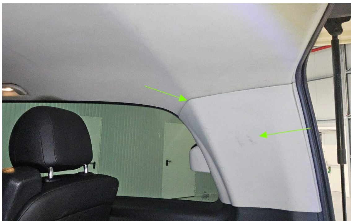
Bild 17 : Dachhimmel dreckig und gerissen
