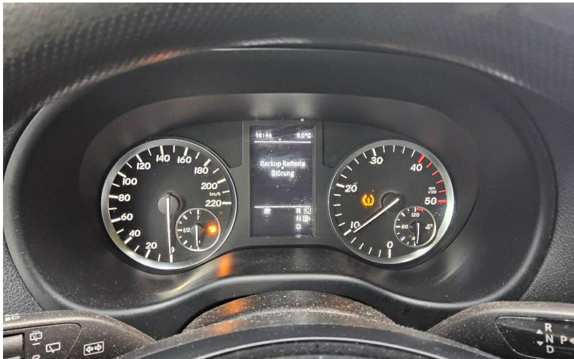
Bild 22 : Fehlermeldung Back Up Batterie
