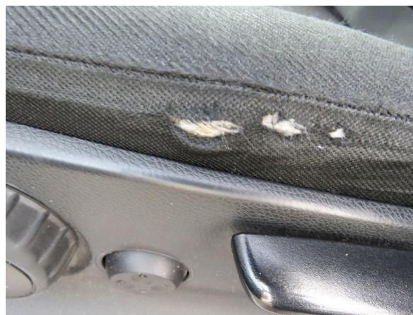
Bild 20: Sitzbezug links beschädigt - erneuern
