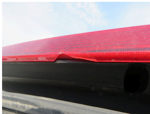
Bild 22: Zusatzbremsleuchte beschädigt - erneuern
