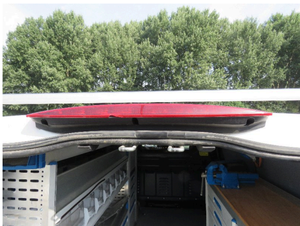
Bild 21: Zusatzbremsleuchte beschädigt - erneuern
