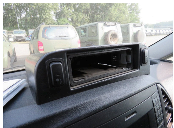
Bild 16: Karosserie Rüstsatz verbaut - Rückrüstung
