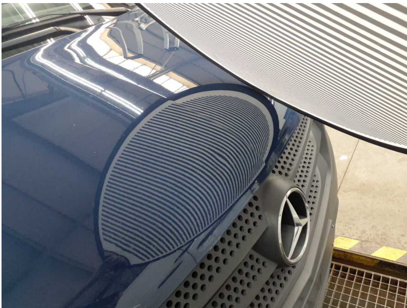
Beschädigung #5: Motorhaube: Motorhaube - Delle(n) - Smart Repair
