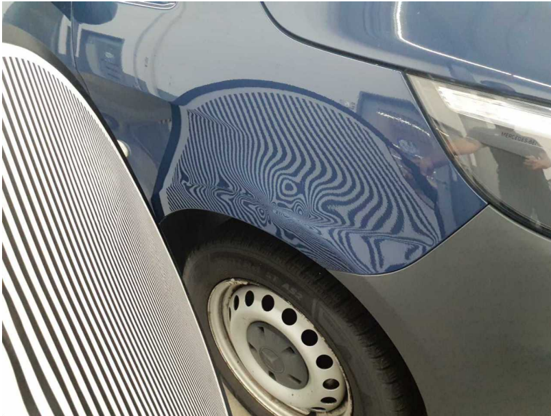
Beschädigung #12: Kotflügel rechts: Kotflügel rechts - verformt - erneuern
