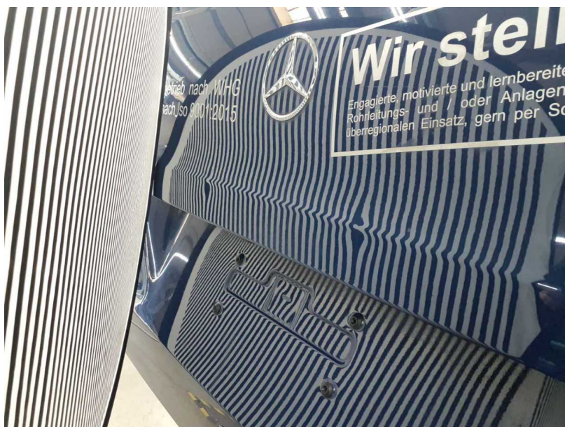
Beschädigung #4: Heckklappe/-tür: Heckklappe - Delle(n) - Smart Repair
