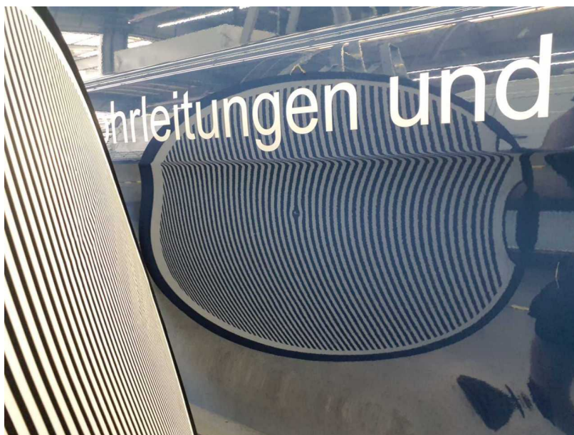
Beschädigung #2: Seitenwand links: Seitenwand - Delle(n) - Smart Repair
