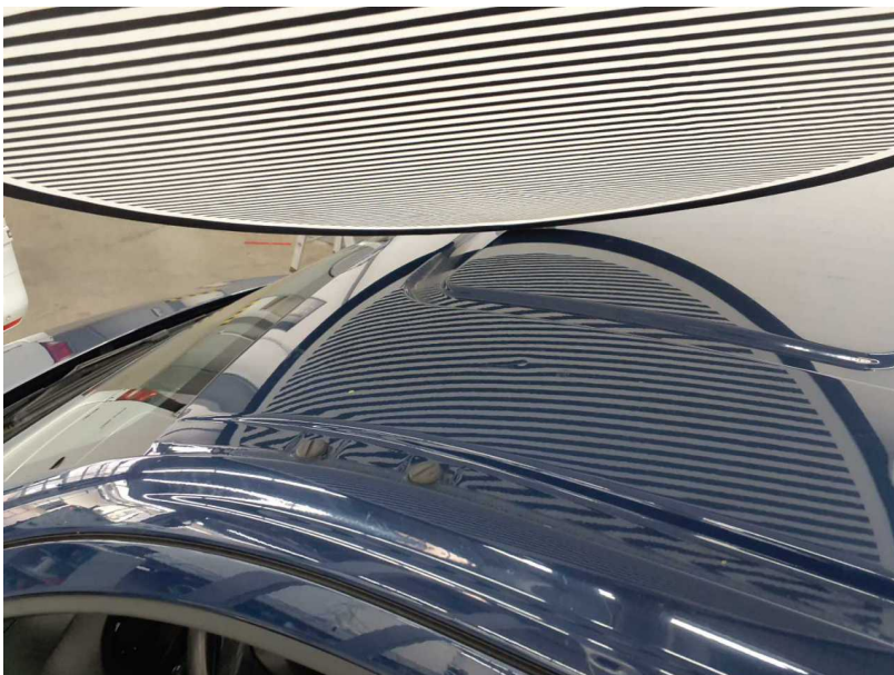
Beschädigung #13: Fahrzeugdach: Dach (Beulen) - beschädigt - instandsetzen und lackieren
