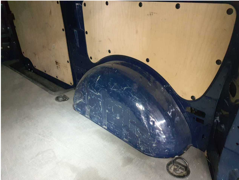
Beschädigung #11: Karosserie: Radhaus hinten rechts (Inkl. links) - verformt - instandsetzen und lackieren
