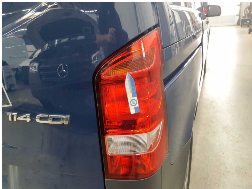
Beschädigung #7: Heckleuchte: Heckleuchte rechts - gebrochen / gerissen - erneuern
