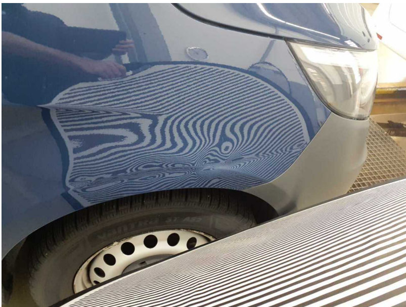
Beschädigung #12: Kotflügel rechts: Kotflügel rechts - verformt - erneuern
