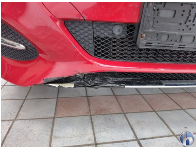
10. Unfallschaden Vorne, Schadenserweiterung möglich
