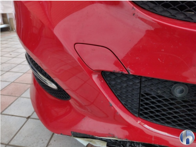
10. Unfallschaden Vorne, Schadenserweiterung möglich
