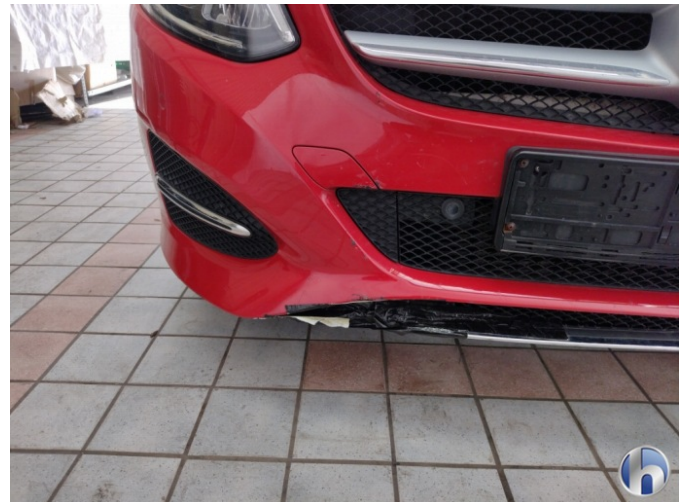
10. Unfallschaden Vorne, Schadenserweiterung möglich
