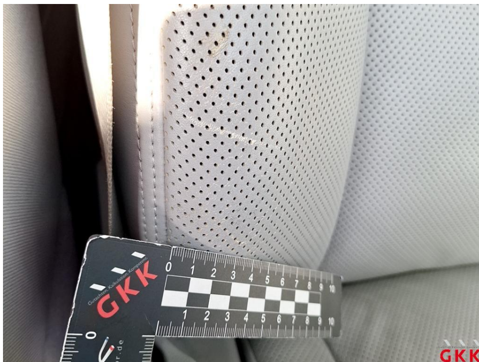
Bild 95 Sitz vorne rechts, Bezug Sitzkissen -Leder-, verkratzt, Smartrepair
