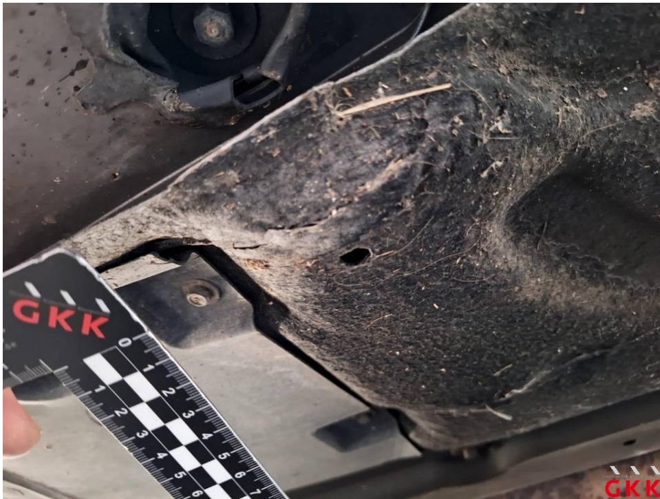
Bild 59 Unterboden, Verkleidung, beschädigt, ersetzen
