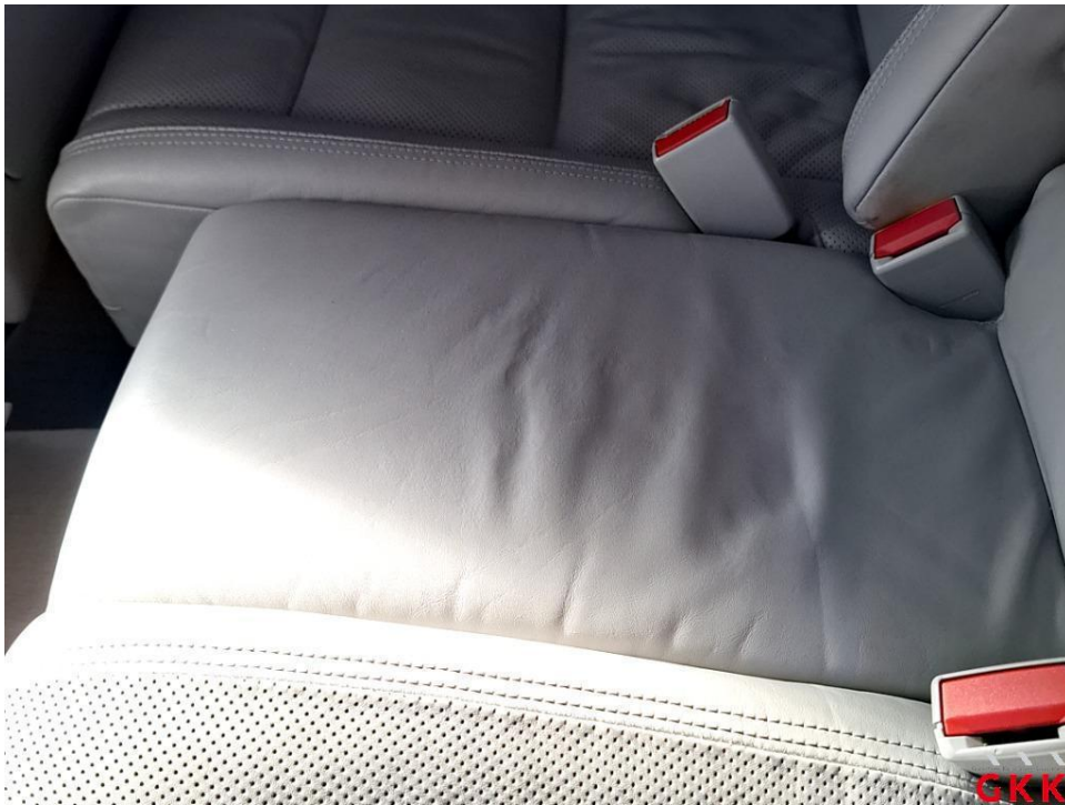
Bild 75 Sitz hinten mitte, Bezug Sitzkissen -Leder-, Druckstellen, aufbereiten
