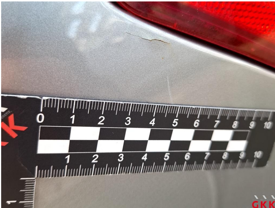
Bild 38 Seitenwand links, Reparaturmangel, instand setzen
