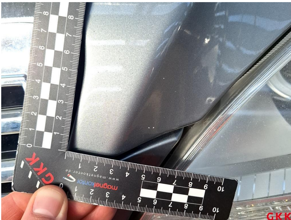
Bild 40 Motorhaube, Steinschlag, lackieren
