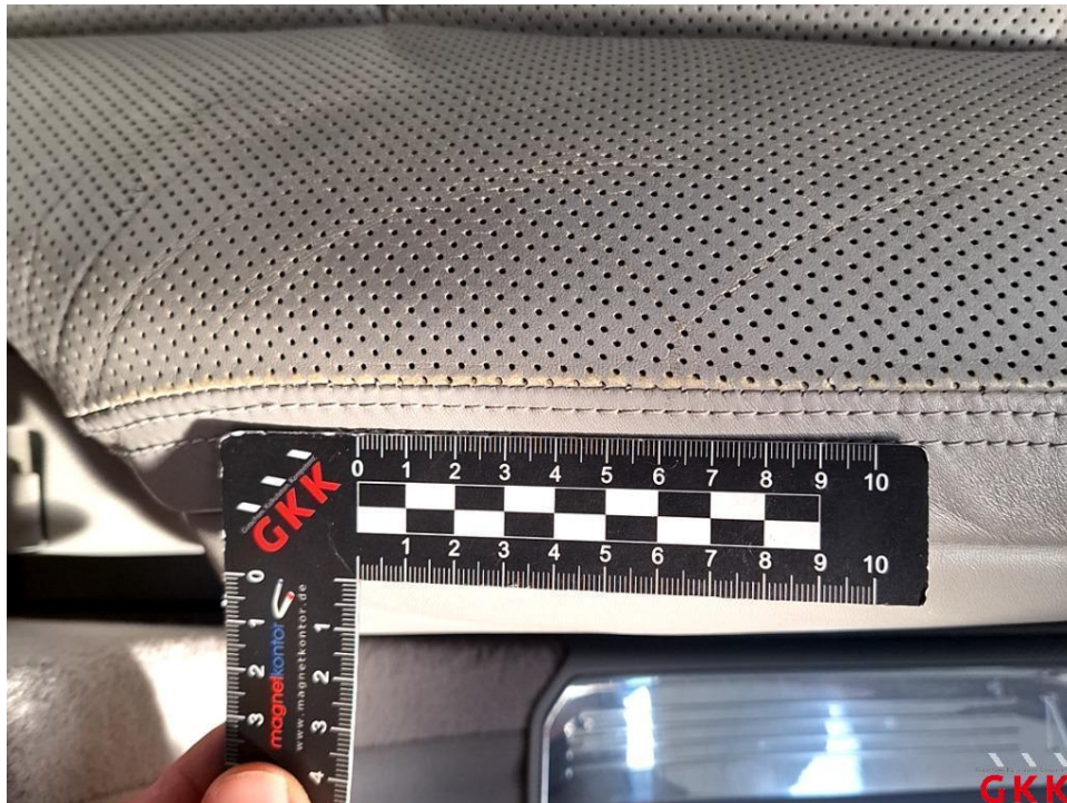
Bild 93 Sitz vorne rechts, Bezug Sitzkissen -Leder-, verkratzt, Smartrepair
