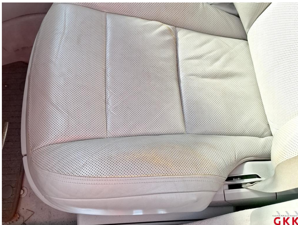
Bild 67 Sitz vorne links, Bezug Sitzkissen -Leder-, verkratzt, Smartrepair
