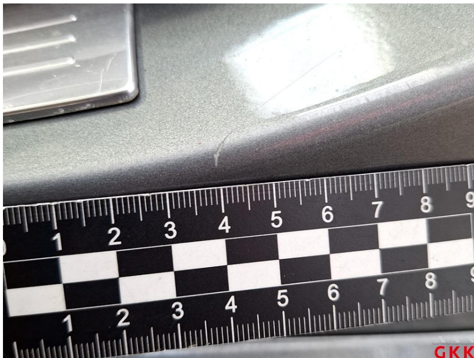
Bild 66 Tür vorne links, Einstieg, verkratzt, auslegen, schleifen, polieren
