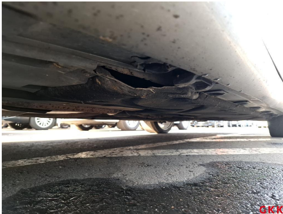
Bild 58 Unterboden, Verkleidung, beschädigt, ersetzen
