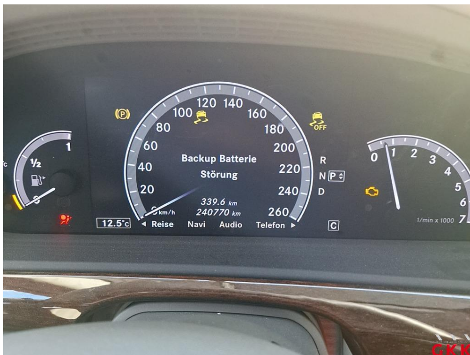
Bild 30 Fahrzeug, Batterie, entladen, ersetzen
