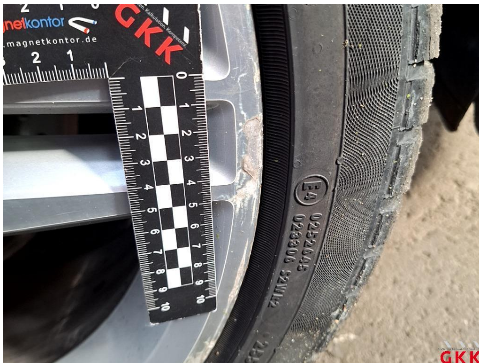
Bild 102 LM-Rad, vorne rechts, Materialabtrag, ersetzen
