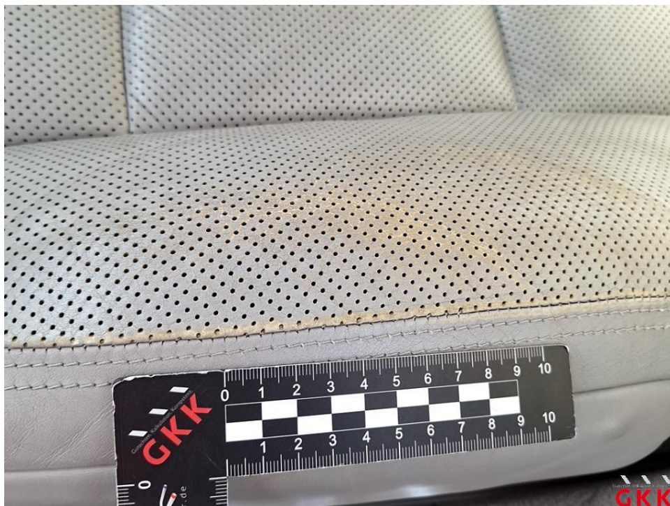
Bild 68 Sitz vorne links, Bezug Sitzkissen -Leder-, verkratzt, Smartrepair
