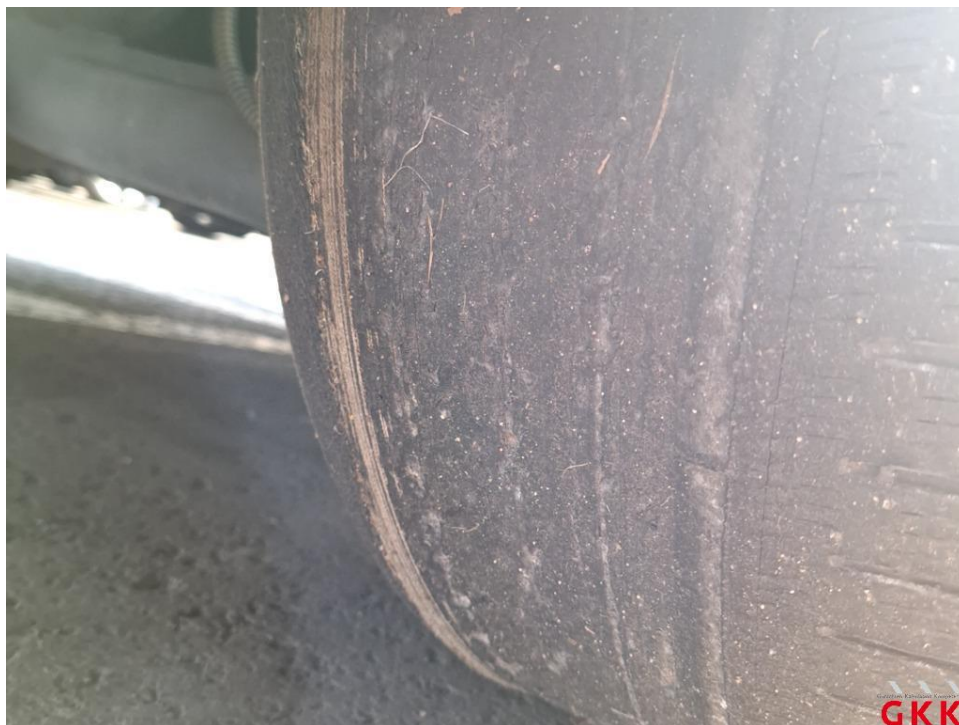
Bild 36 Reifen, hinten links und rechts, beschädigt und Untermaß, ersetzen
