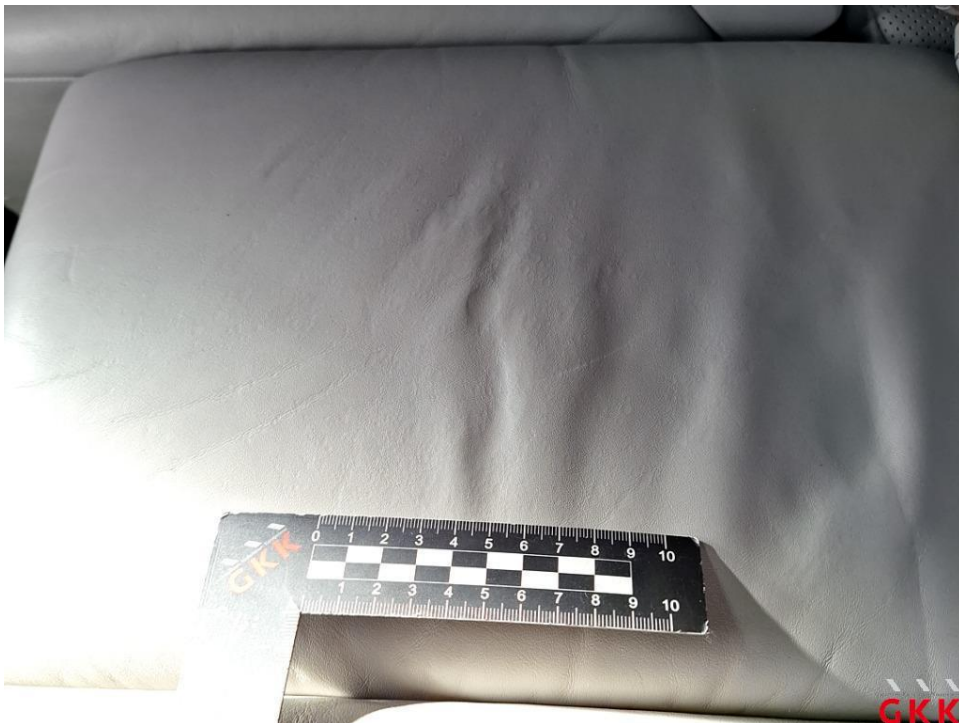
Bild 76 Sitz hinten mitte, Bezug Sitzkissen -Leder-, Druckstellen, aufbereiten
