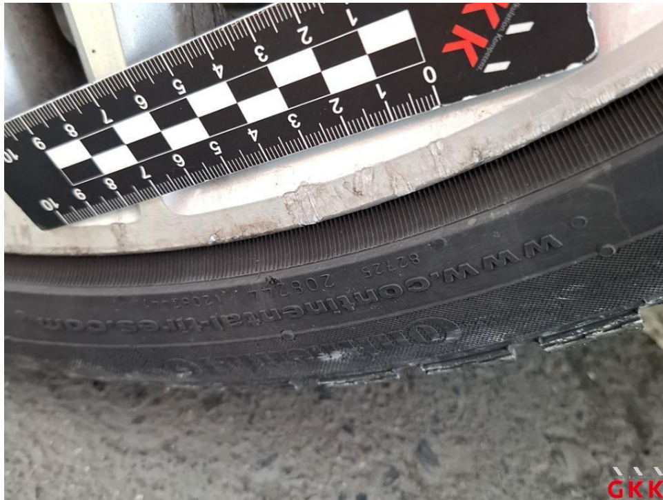
Bild 57 LM-Rad, vorne links, Materialabtrag, ersetzen
