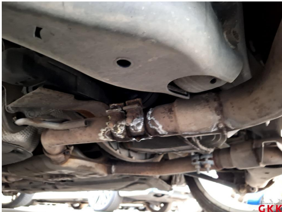
Bild 108 Abgassystem, undicht, prüfen
