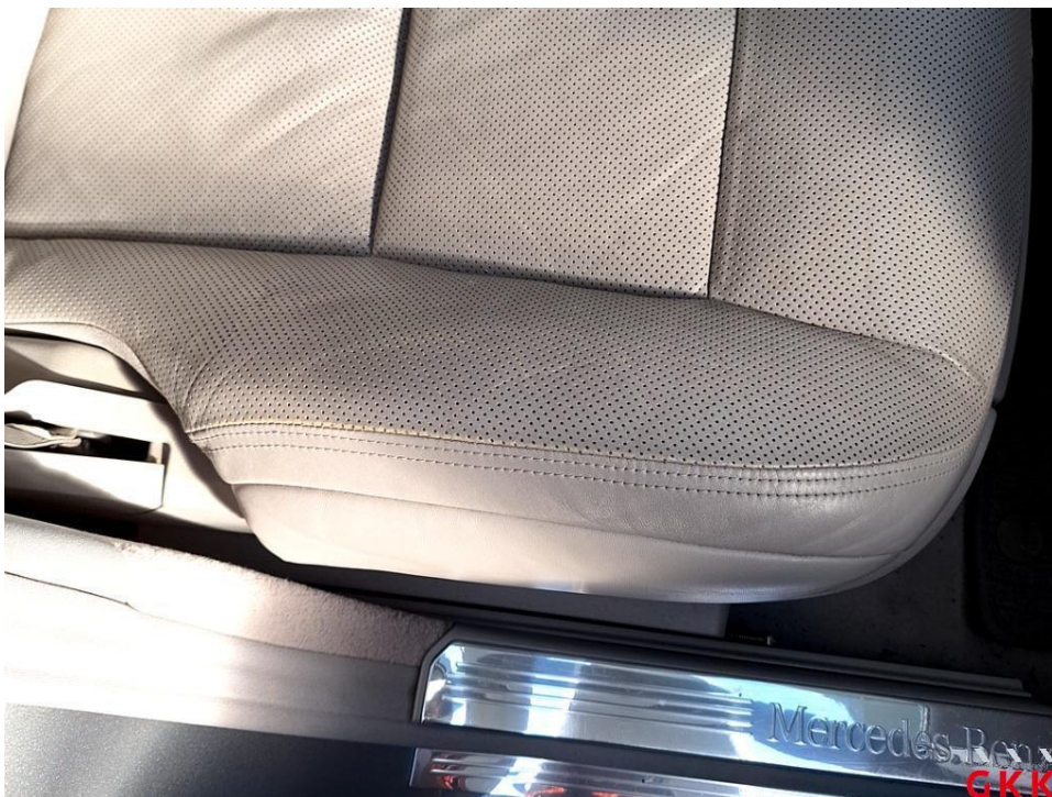
Bild 92 Sitz vorne rechts, Bezug Sitzkissen -Leder-, verkratzt, Smartrepair
