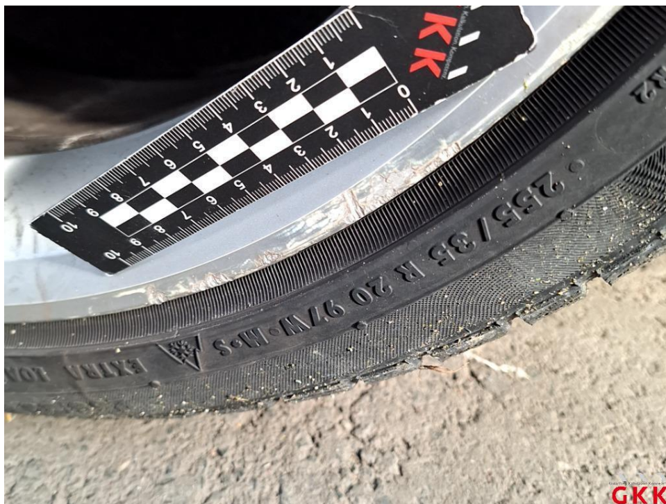
Bild 101 LM-Rad, vorne rechts, Materialabtrag, ersetzen
