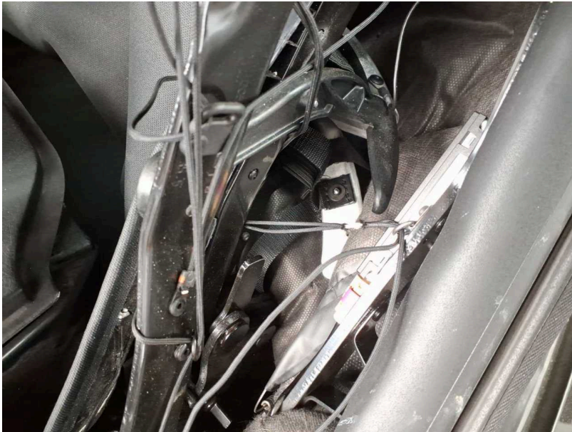
Beschädigung #26: Fahrzeugdach: Verdeck (Bowdenzug li./re.) - gebrochen / gerissen - erneuern
