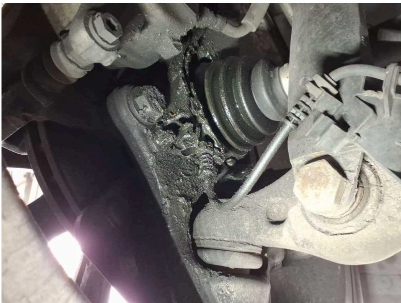
Beschädigung #13: Antriebsstrang: Manschette Gelenkwelle vorn links (Kostenausweitung möglich) - gebrochen / gerissen - erneuern
