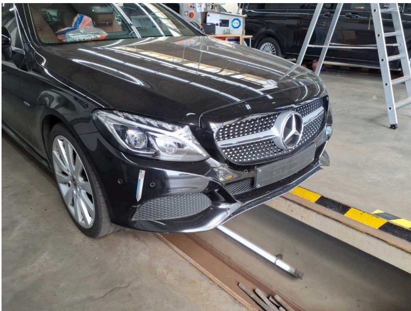
Beschädigung #15: Stossfänger vorn: Stossfänger mit Parktronic - verkratzt / verschürft - lackieren
