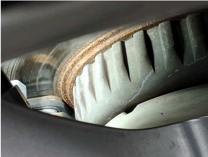
Beschädigung #12: Bremsanlage: Bremsbeläge hinten - verschlissen - erneuern
