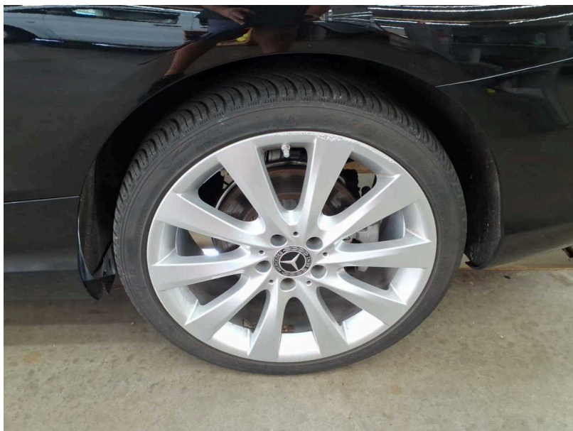
Beschädigung #20: Rad/Reifen: Leichtmetallfelge hinten links - verkratzt / verschürft - erneuern
