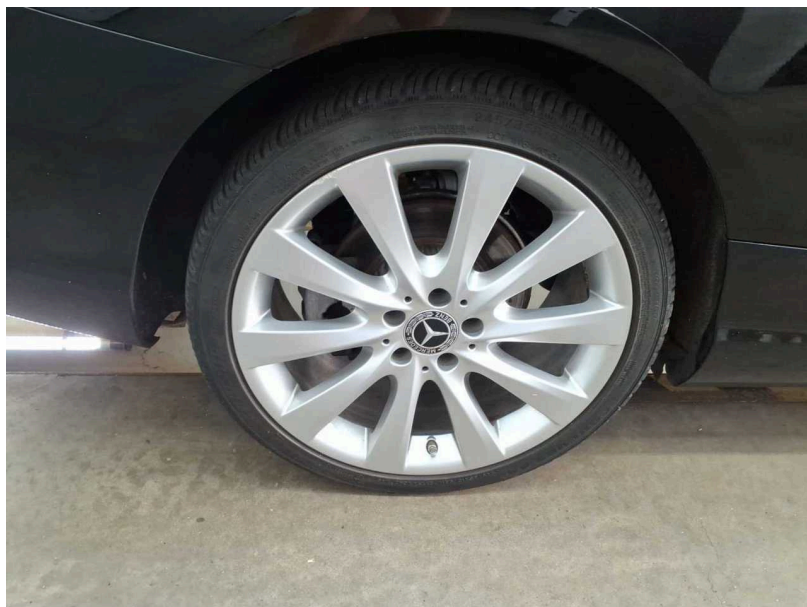
Beschädigung #21: Rad/Reifen: Leichtmetallfelge hinten rechts - verkratzt / verschürft - erneuern
