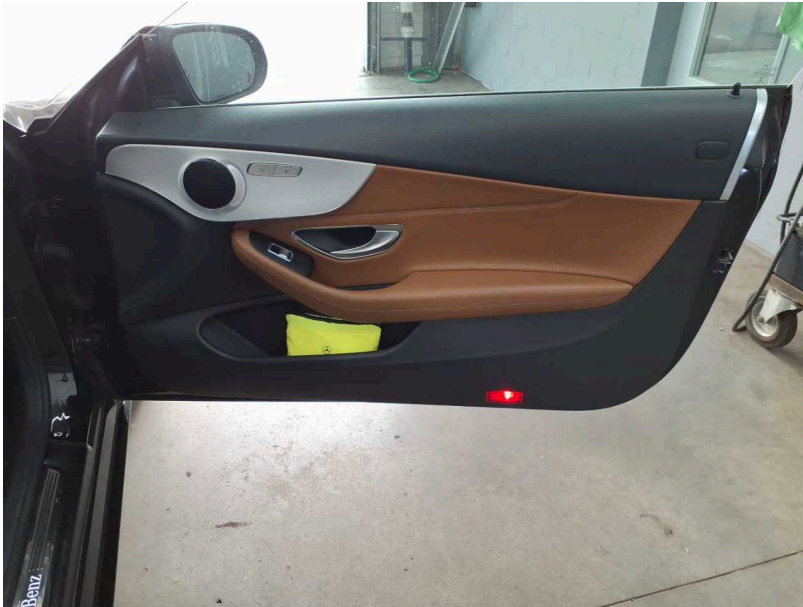
Beschädigung #4: Verkleidungen/Abdeckungen: Türverkleidung vorn rechts - verformt - Smart Repair
