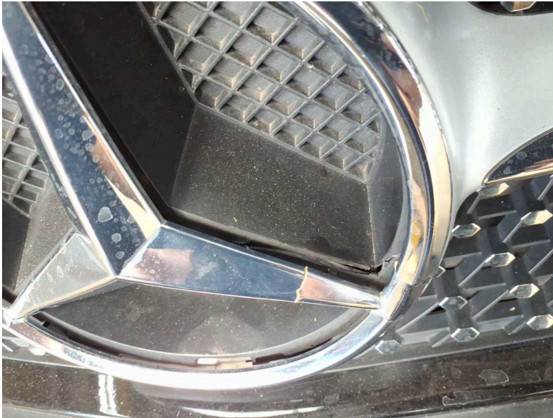
Beschädigung #18: Motorhaube: Kühlergrill - gebrochen / gerissen - erneuern
