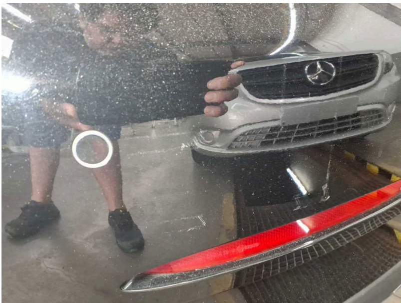
Beschädigung #24: Stossfänger hinten: Stossfänger mit Parktronic - verformt - erneuern
