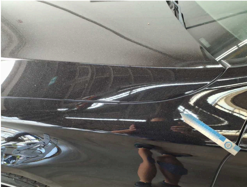
Beschädigung #19: Kotflügel links: Kotflügel links - verformt - erneuern
