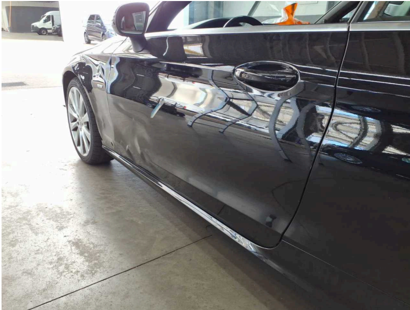
Beschädigung #25: Tür vorn links: Tür - verformt - erneuern
