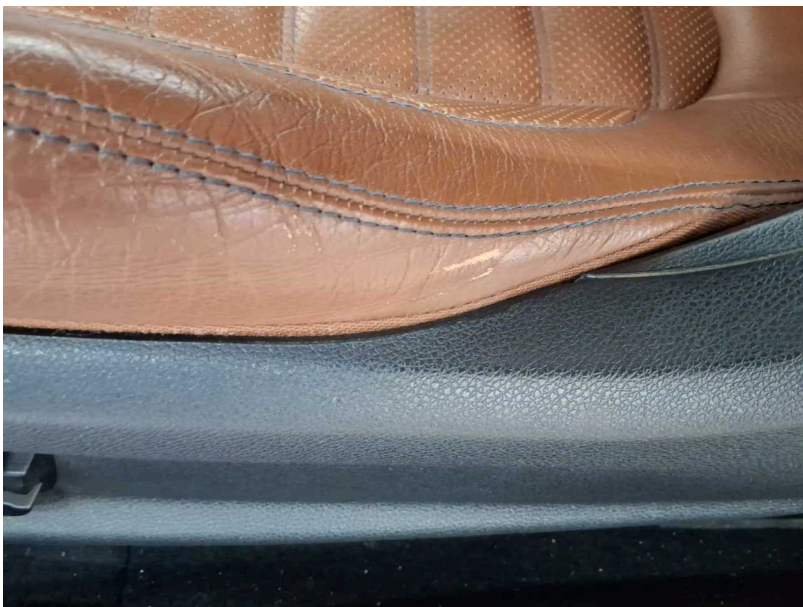
Beschädigung #3: Sitz vorn: Sitzbezug links - gebrochen / gerissen - Smart Repair
