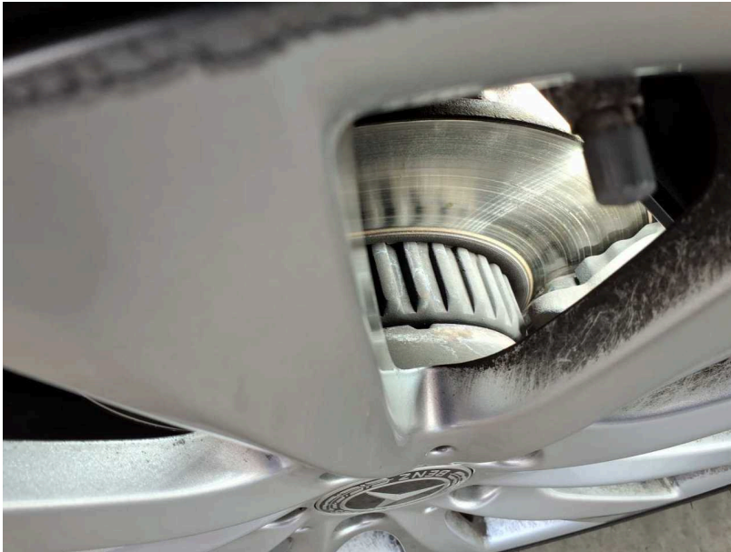
Beschädigung #16: Bremsanlage: Bremsscheiben und Beläge vorn - verschlissen - erneuern
