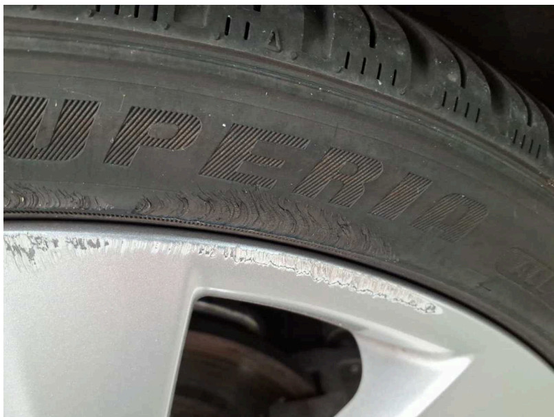
Beschädigung #1: Rad/Reifen: Reifen hinten (li./re.) - gebrochen / gerissen - kein Abzug
