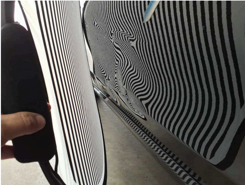
Beschädigung #25: Tür vorn links: Tür - verformt - erneuern
