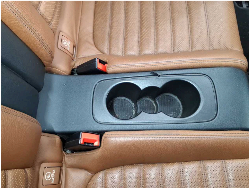
Beschädigung #14: Interieur: Innenraum - gebrochen / gerissen - erneuern
