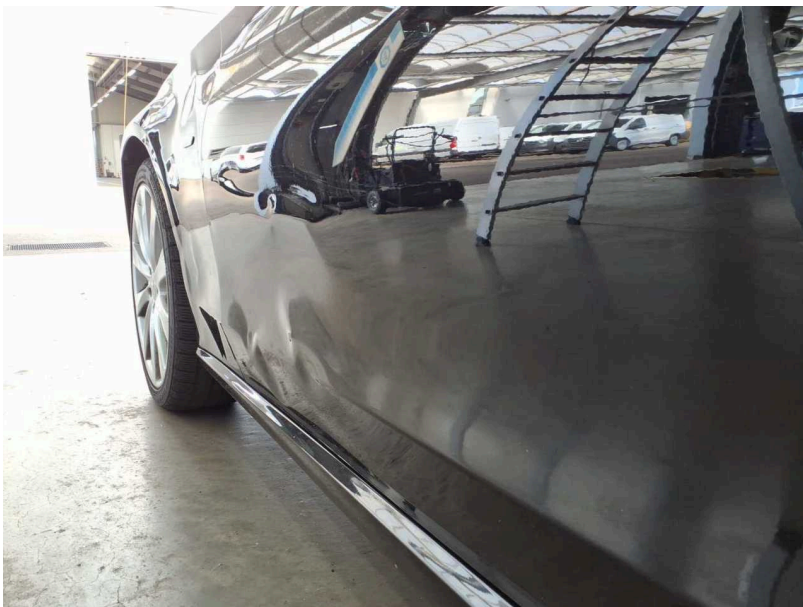
Beschädigung #25: Tür vorn links: Tür - verformt - erneuern
