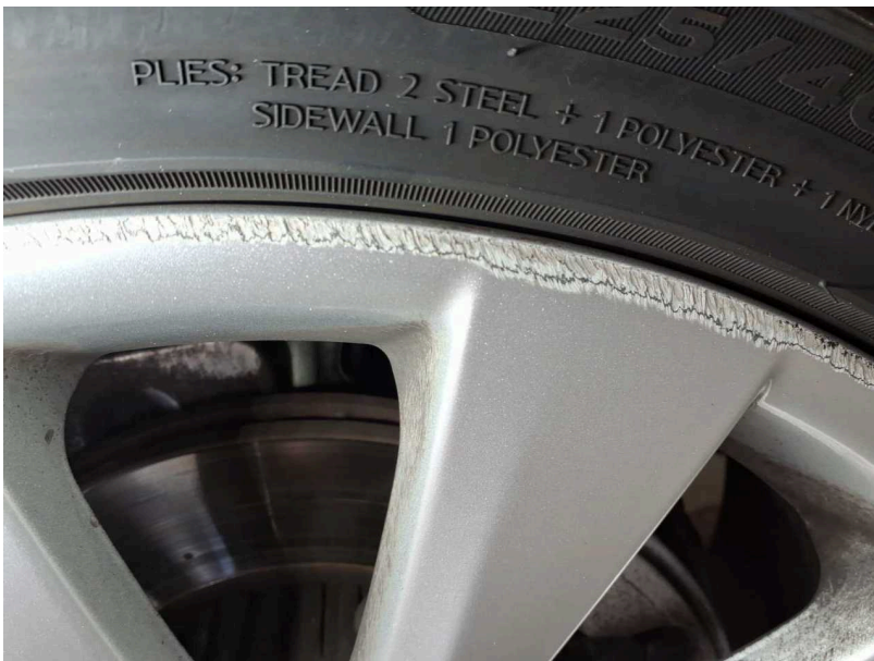
Beschädigung #22: Rad/Reifen: Leichtmetallfelge vorn links - verkratzt / verschürft - erneuern
