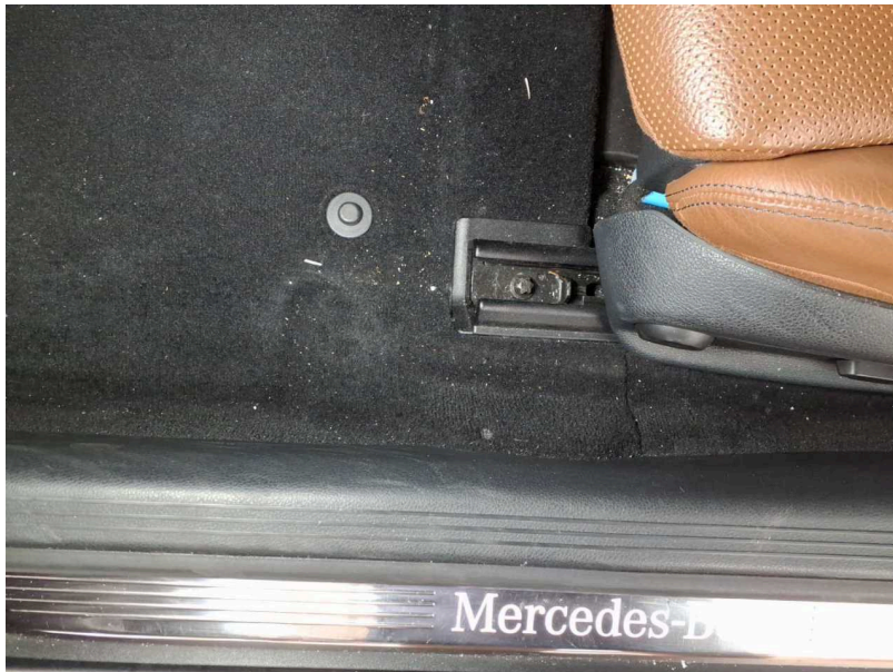
Beschädigung #7: Verkleidungen/Abdeckungen: Teppichboden vorn links - Brandloch - Smart Repair
