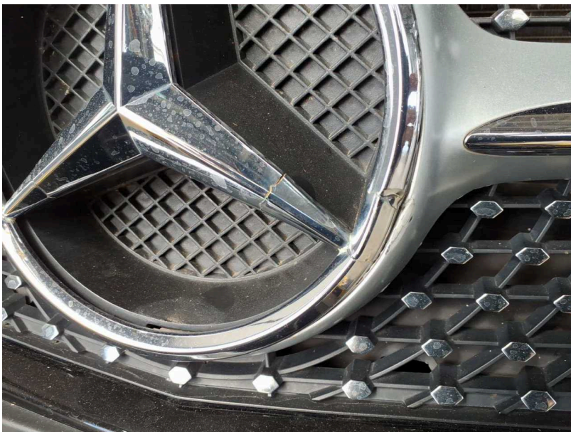
Beschädigung #18: Motorhaube: Kühlergrill - gebrochen / gerissen - erneuern
