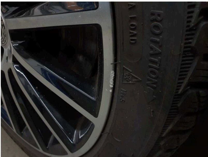
Beschädigung #7: Rad/Reifen: Leichtmetallfelge vorn rechts - beschädigt - erneuern
