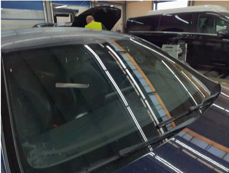
Beschädigung #5: Verglasung: Frontscheibe mit Spurhalteassistent - Kratzer - erneuern
