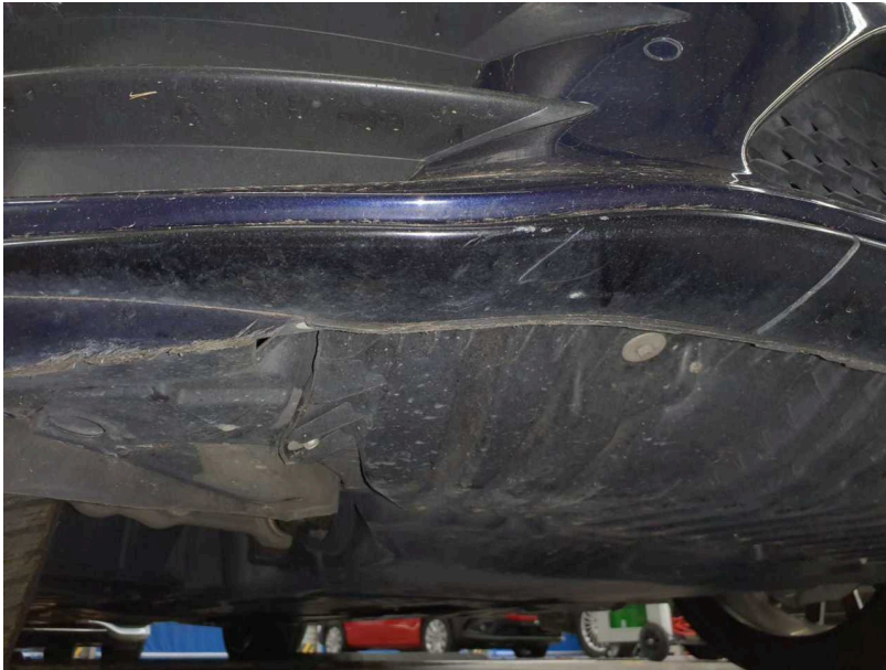
Beschädigung #3: Stossfänger vorn: Stossfänger mit Parktronic - verkratzt / verschürft - lackieren
