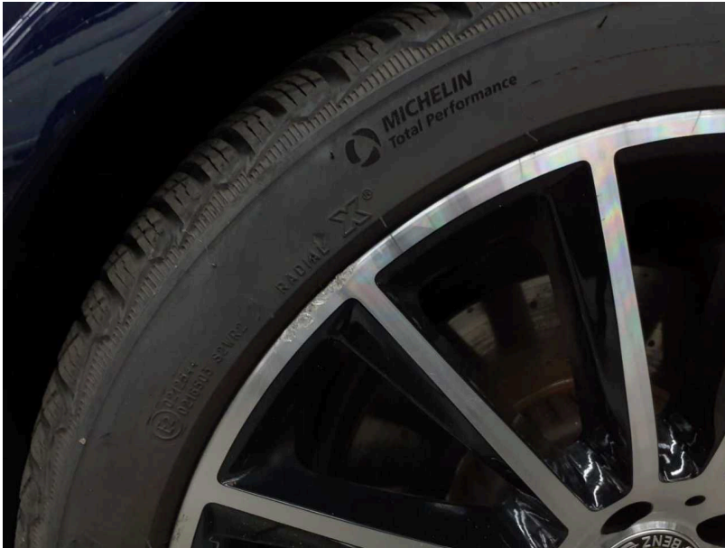
Beschädigung #6: Rad/Reifen: Leichtmetallfelge vorn links - beschädigt - erneuern
