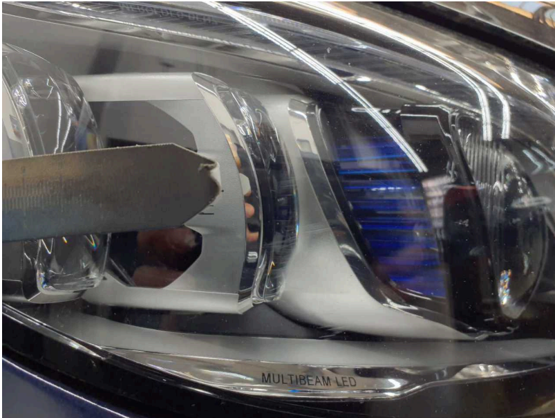
Beschädigung #9: Scheinwerfer: LED-Scheinwerfer rechts - Kratzer - erneuern
