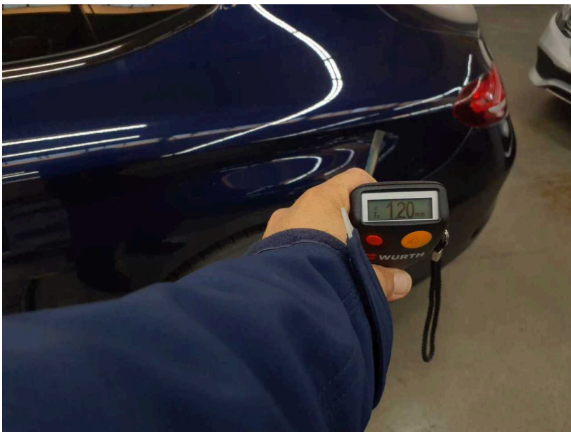
Beschädigung #4: Seitenwand links: Seitenwand - nicht fachgerecht instandgesetzt - instandsetzen und lackieren
