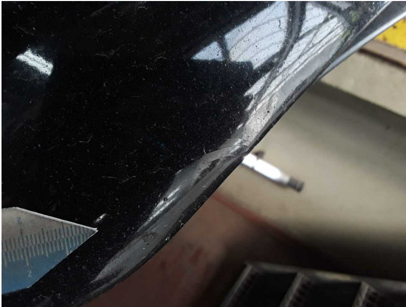
Beschädigung #6: Stossfänger vorn: Stossfänger mit Parktronic - Lackmangel - lackieren
