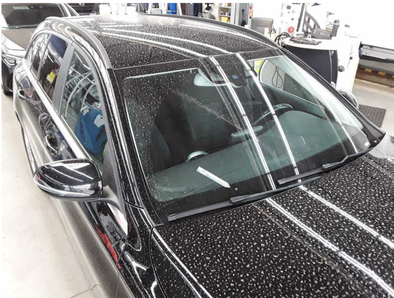
Beschädigung #8: Verglasung: Frontscheibe mit Spurhalteassistent - Steinschlag - erneuern
