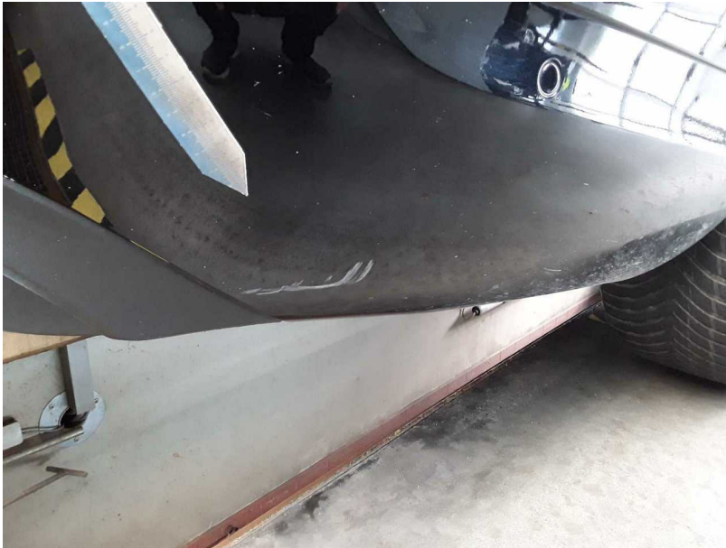
Beschädigung #4: Stossfänger hinten: Stossfänger mit Parktronic - Kratzer - lackieren
