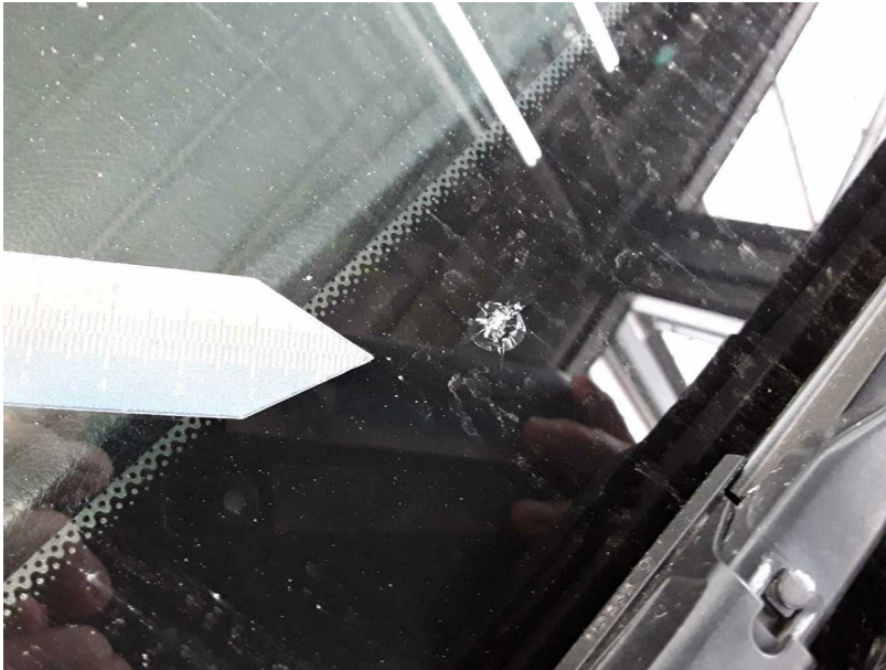
Beschädigung #8: Verglasung: Frontscheibe mit Spurhalteassistent - Steinschlag - erneuern
