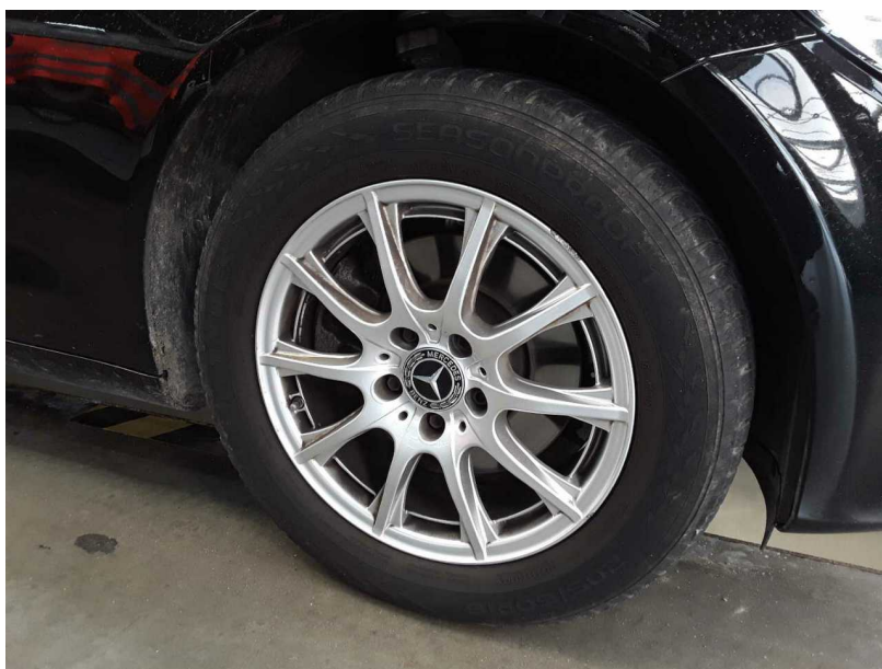
Beschädigung #2: Rad/Reifen: Leichtmetallfelge vorn rechts - beschädigt - erneuern
