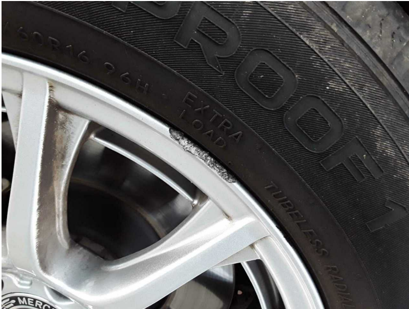
Beschädigung #2: Rad/Reifen: Leichtmetallfelge vorn rechts - beschädigt - erneuern
