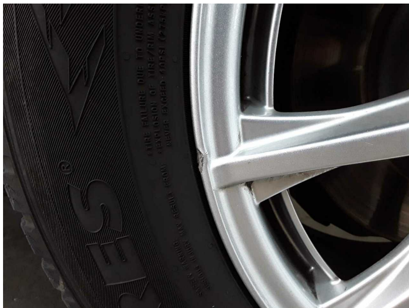
Beschädigung #3: Rad/Reifen: Leichtmetallfelge hinten links - beschädigt - erneuern
