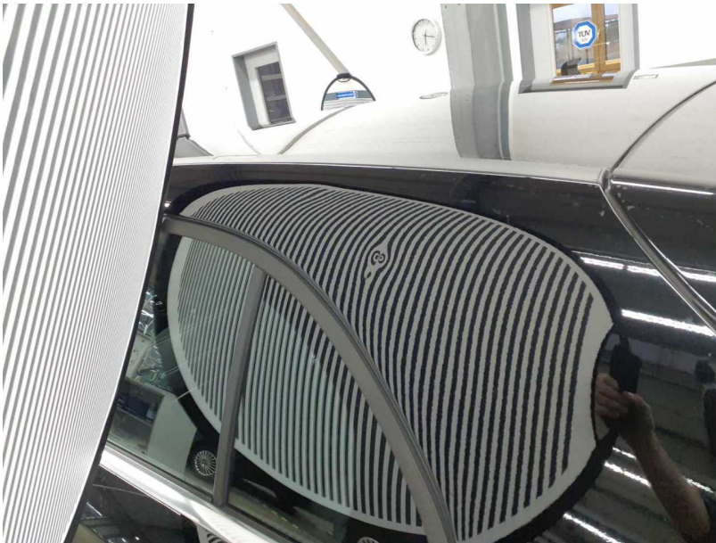
Beschädigung #3: Fahrzeugdach: Dachholm links - Delle / Lackschaden - instandsetzen und lackieren
