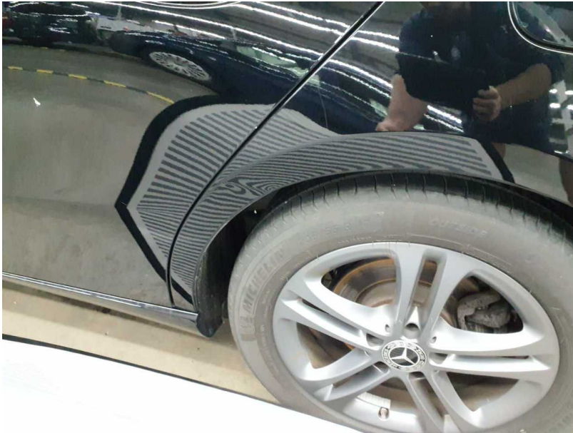
Beschädigung #6: Seitenwand links: Seitenwand - verformt - instandsetzen und lackieren
