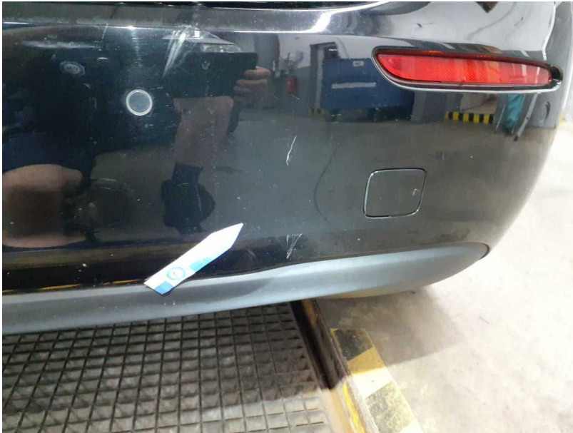
Beschädigung #7: Stossfänger hinten: Stossfänger mit Parktronic - verkratzt / verschürft - lackieren
