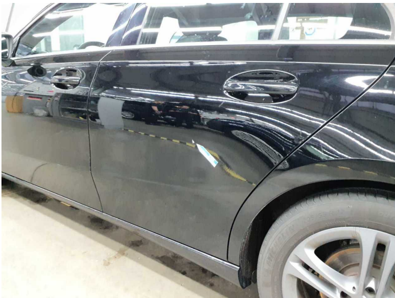
Beschädigung #8: Tür hinten links: Tür - Lackmangel - lackieren
