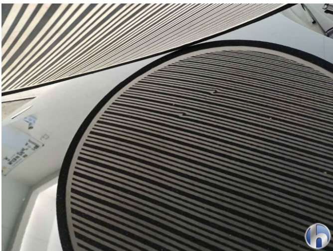
34. Motorhaube mit 30 Dellen à 20mm-30mm und einer Verformung mit Kratzer
