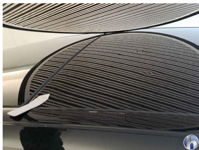
24. Dach mit 15 Dellen à 20mm-30mm
