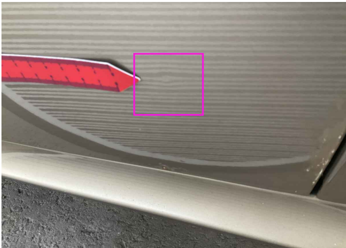
23. Door / Front Left Bodywork / Dent / Dent -
