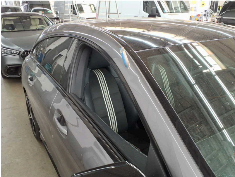
Beschädigung #15: Fahrzeugdach: Dachholm rechts - Delle(n) - Smart Repair
