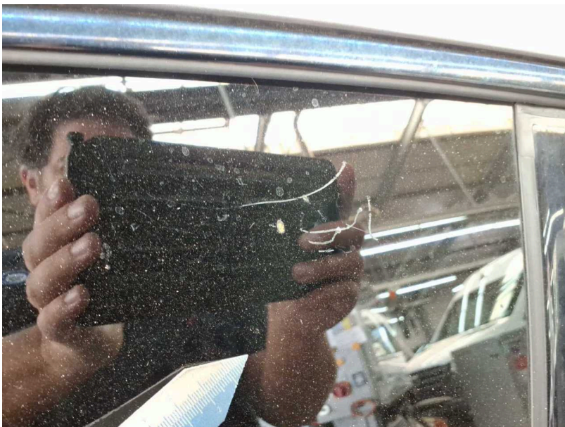
Beschädigung #17: Verglasung: Seitenscheibe hinten links - verkratzt / verschürft - erneuern
