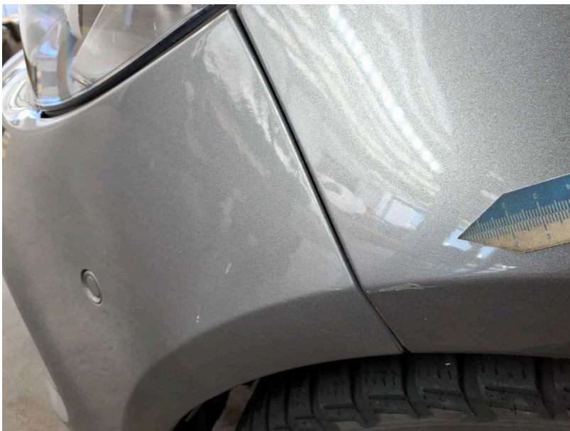
Beschädigung #21: Kotflügel links: Kotflügel links - verkratzt / verschürft - lackieren
