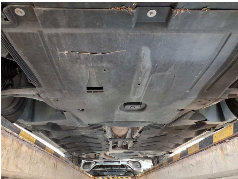
Beschädigung #14: Karosserie: Unterbodenverkleidung - gebrochen / gerissen - erneuern
