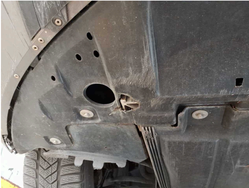
Beschädigung #14: Karosserie: Unterbodenverkleidung - gebrochen / gerissen - erneuern
