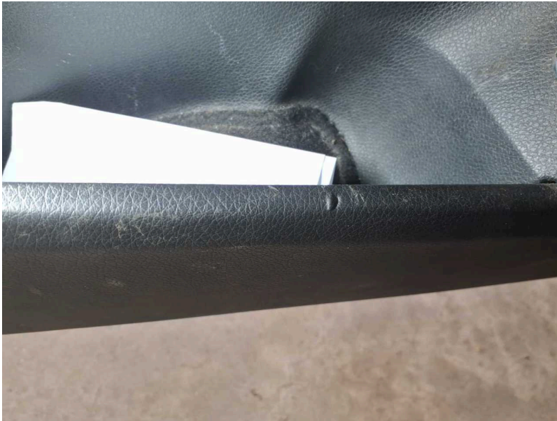
Beschädigung #13: Verkleidungen/Abdeckungen: Türverkleidung vorn links - verformt - Smart Repair
