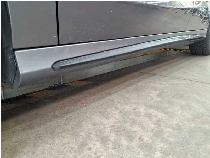
Beschädigung #20: Schweller links: Verkleidung - verkratzt / verschürft - lackieren
