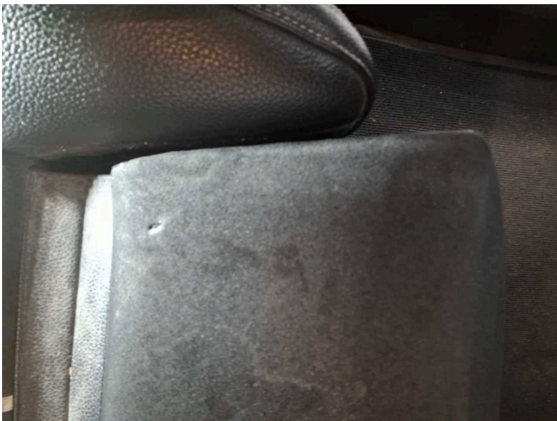
Beschädigung #22: Sitz vorn: Sitzbezug links - Brandloch - erneuern
