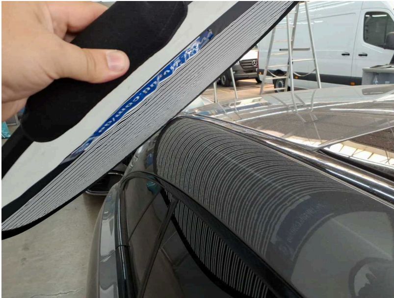
Beschädigung #15: Fahrzeugdach: Dachholm rechts - Delle(n) - Smart Repair
