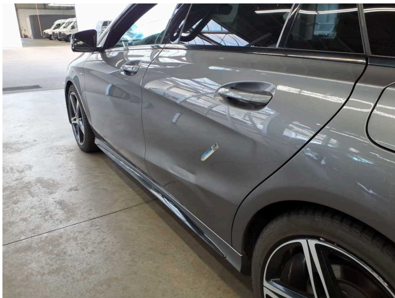
Beschädigung #25: Tür vorn links: Tür - verformt - instandsetzen und lackieren
