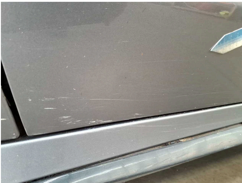
Beschädigung #24: Tür vorn links: Tür - verkratzt / verschürft - lackieren
