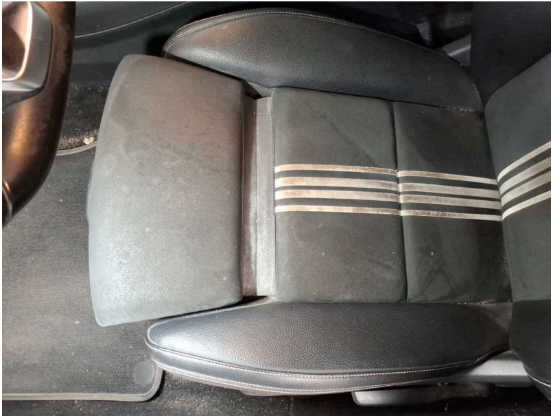
Beschädigung #22: Sitz vorn: Sitzbezug links - Brandloch - erneuern
