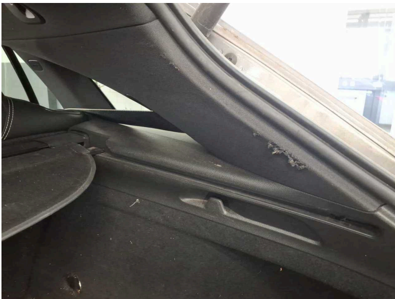
Beschädigung #16: Verkleidungen/Abdeckungen: C-Säule rechts Verkleidung innen - gebrochen / gerissen - erneuern
