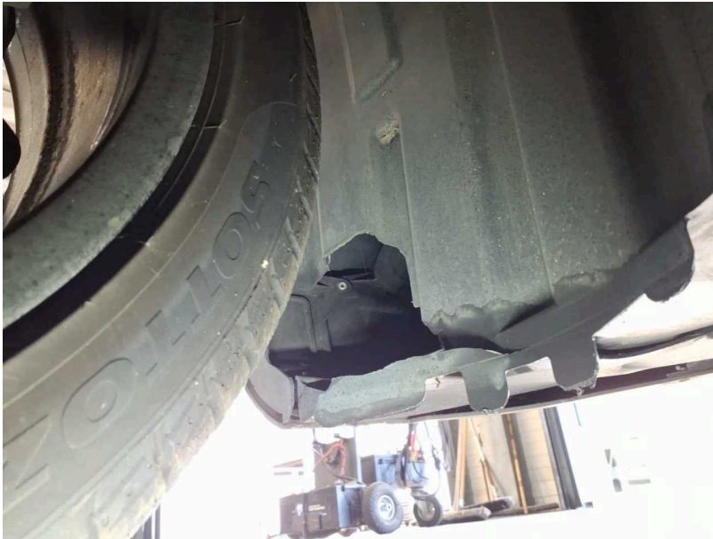
Beschädigung #8: Kotflügel links: Innenkotflügel - gebrochen / gerissen - erneuern
