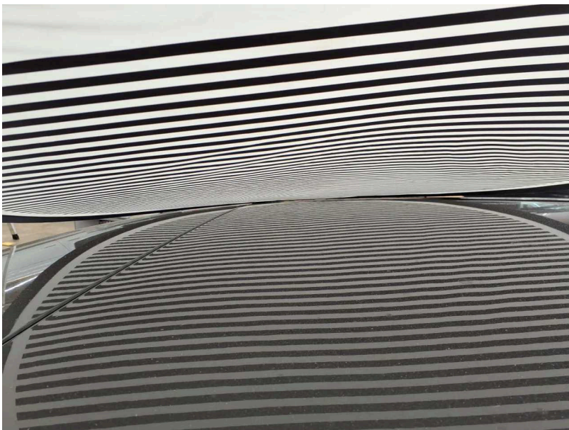
Beschädigung #19: Fahrzeugdach: Dach (Ca.15 Dellen) - Hagelschaden - Smart Repair
