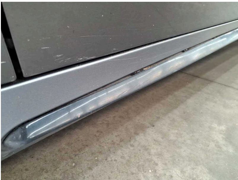
Beschädigung #20: Schweller links: Verkleidung - verkratzt / verschürft - lackieren
