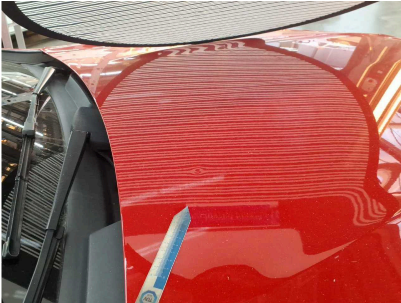
Beschädigung #6: Motorhaube: Motorhaube - Delle(n) - Smart Repair
