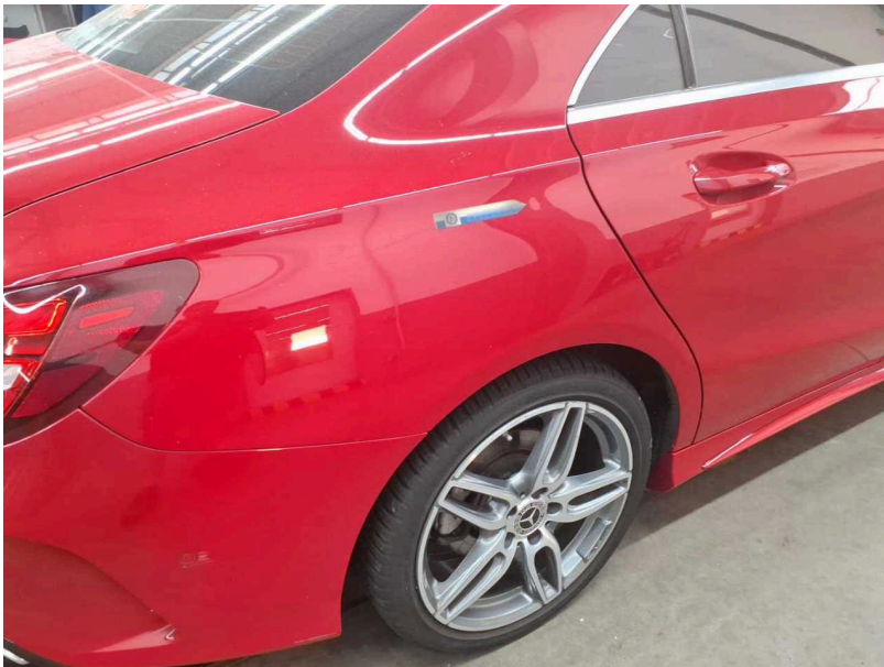
Beschädigung #2: Seitenwand rechts: Seitenwand - Delle(n) - Smart Repair
