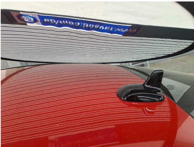
Beschädigung #8: Fahrzeugdach: Dach - Hagelschaden - Smart Repair
