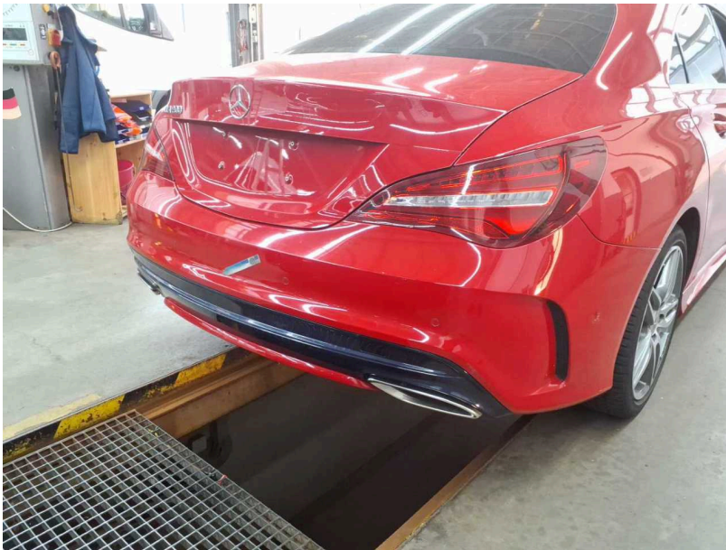
Beschädigung #11: Stossfänger hinten: Stossfänger mit Parktronic - verkratzt / verschürft - lackieren
