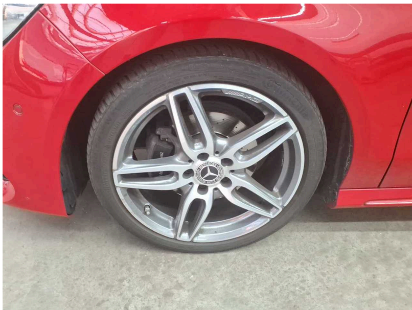
Beschädigung #16: Rad/Reifen: Leichtmetallfelge vorn links - verkratzt / verschürft - erneuern
