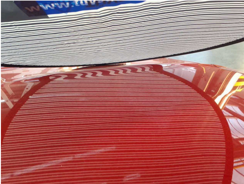
Beschädigung #6: Motorhaube: Motorhaube - Delle(n) - Smart Repair
