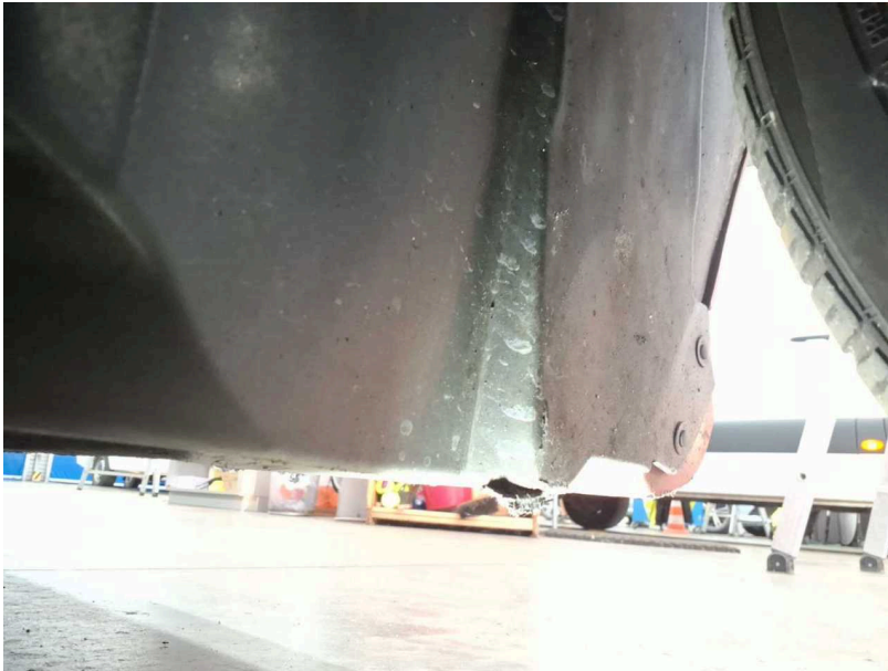
Beschädigung #4: Kotflügel links: Innenkotflügel - gebrochen / gerissen - erneuern
