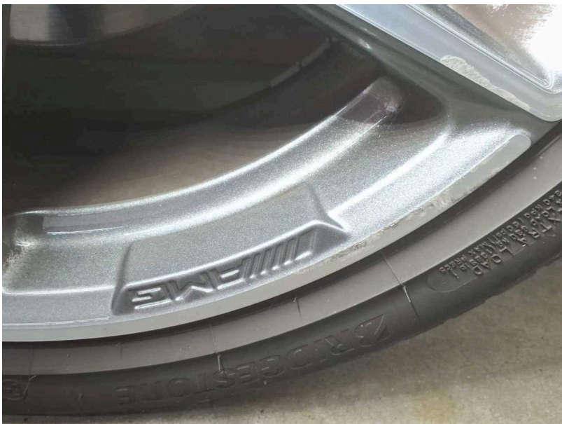
Beschädigung #14: Rad/Reifen: Leichtmetallfelge hinten links - verkratzt / verschürft - erneuern
