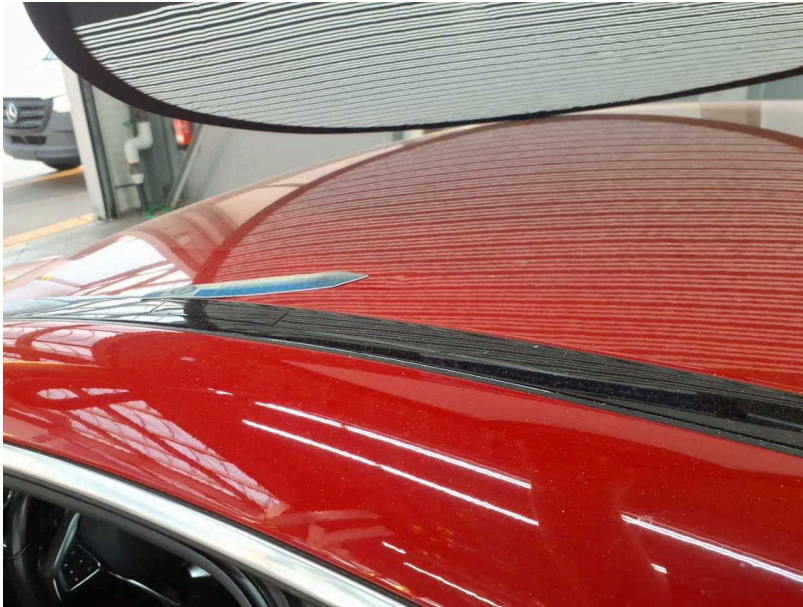
Beschädigung #8: Fahrzeugdach: Dach - Hagelschaden - Smart Repair
