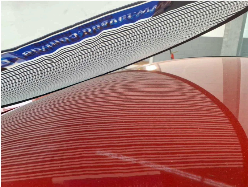
Beschädigung #8: Fahrzeugdach: Dach - Hagelschaden - Smart Repair
