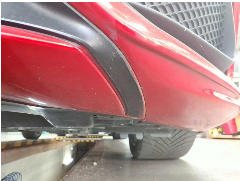
Beschädigung #13: Stossfänger vorn: Stossfänger mit Parktronic (Inkl.blende li./re.) - verkratzt / verschürft - lackieren
