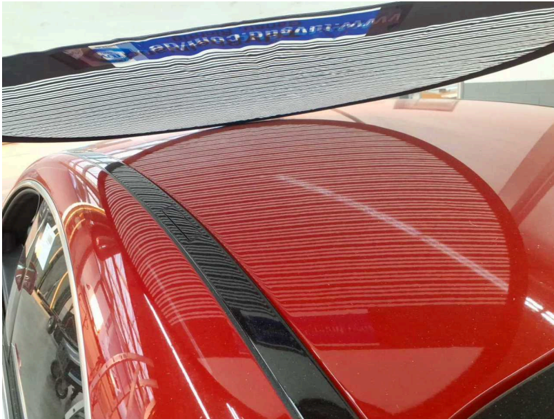
Beschädigung #8: Fahrzeugdach: Dach - Hagelschaden - Smart Repair
