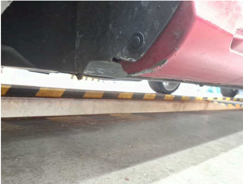
Beschädigung #12: Schweller links: Verkleidung - gebrochen / gerissen - erneuern
