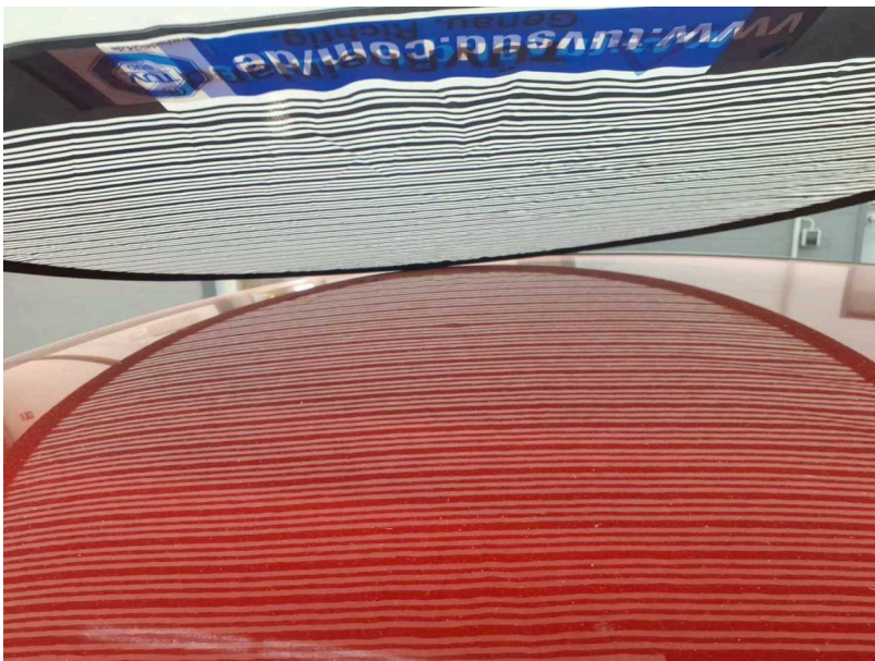
Beschädigung #8: Fahrzeugdach: Dach - Hagelschaden - Smart Repair
