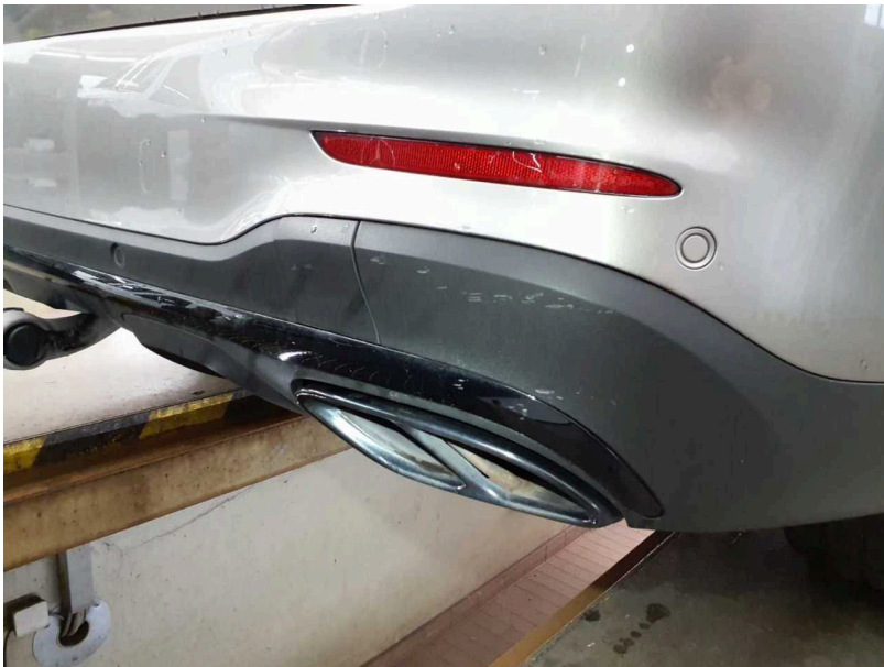
Beschädigung #6: Stossfänger hinten: Spoiler - verkratzt / verschürft - erneuern
