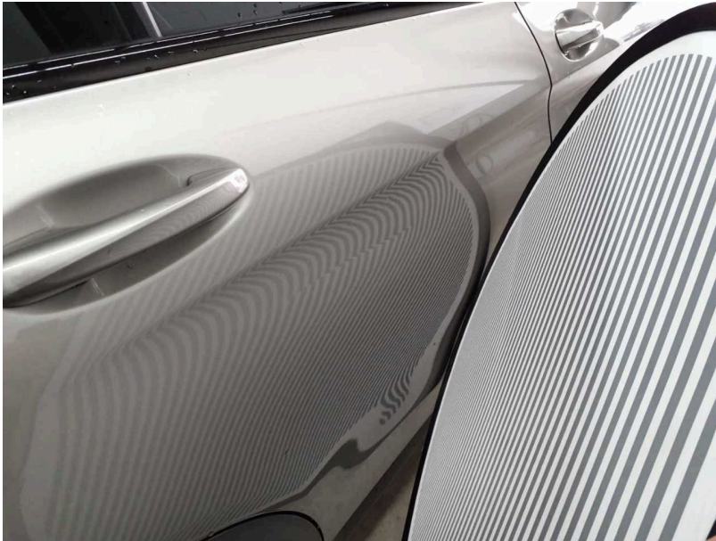
Beschädigung #8: Tür hinten rechts: Tür - verformt - instandsetzen und lackieren
