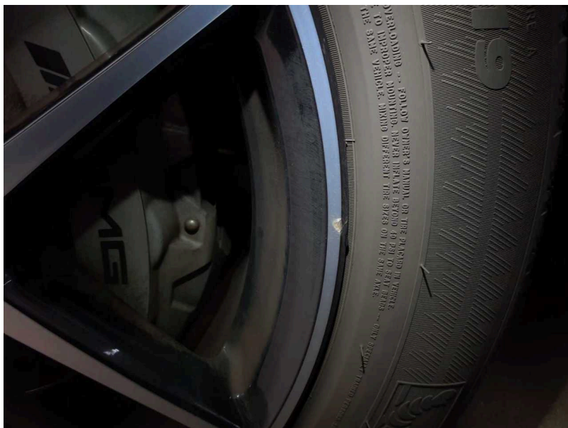
Beschädigung #10: Rad/Reifen: Leichtmetallfelge vorn links - verkratzt / verschürft - erneuern
