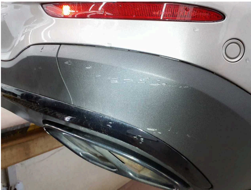
Beschädigung #6: Stossfänger hinten: Spoiler - verkratzt / verschürft - erneuern
