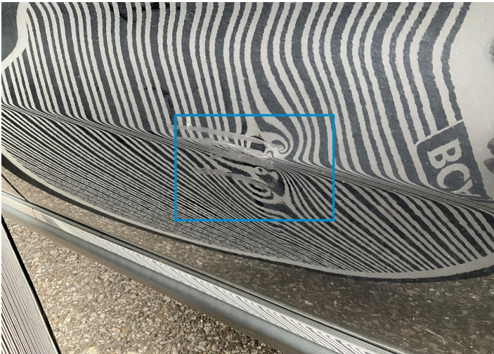
10. Door / Back Left Bodywork / Dent / Dent -
