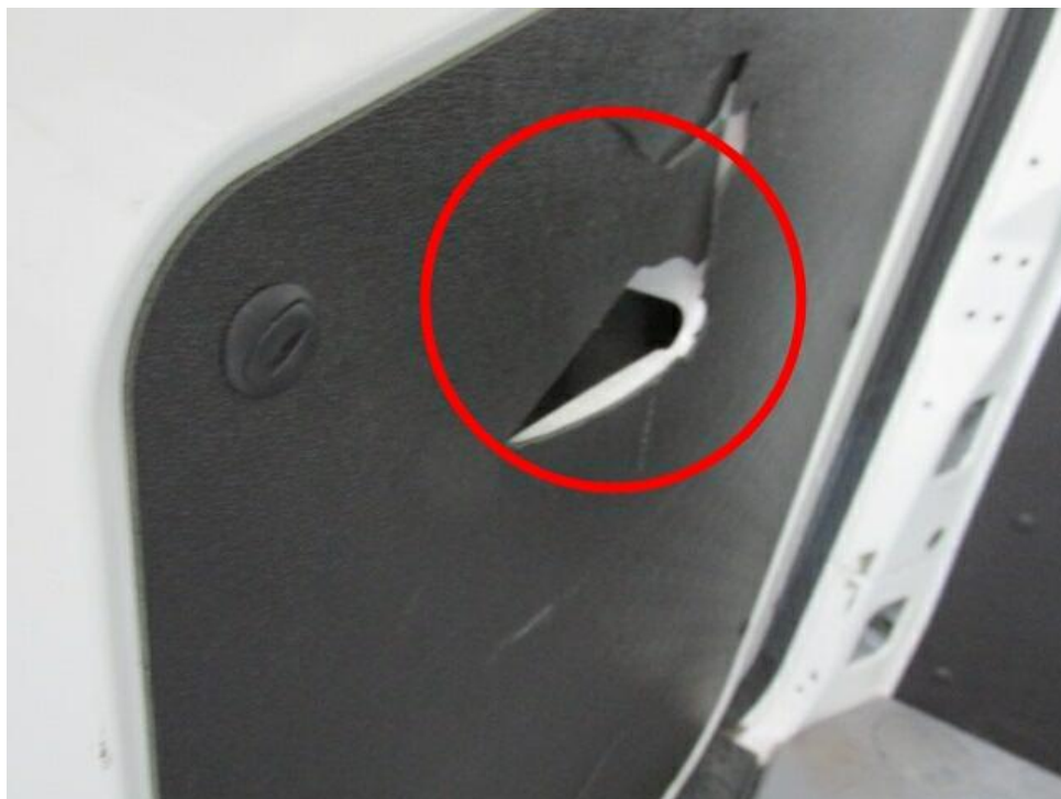
Bild 12 : Verkleidung Türe hinten rechts gebrochen
