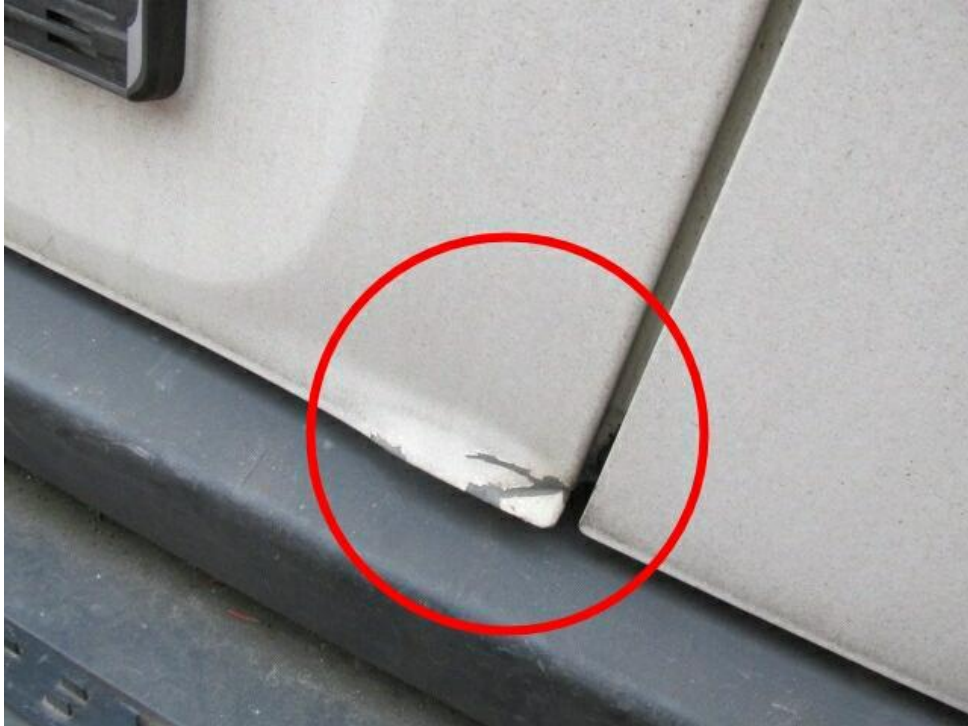
Bild 17 : Türe hinten links im Kantenbereich deformiert
