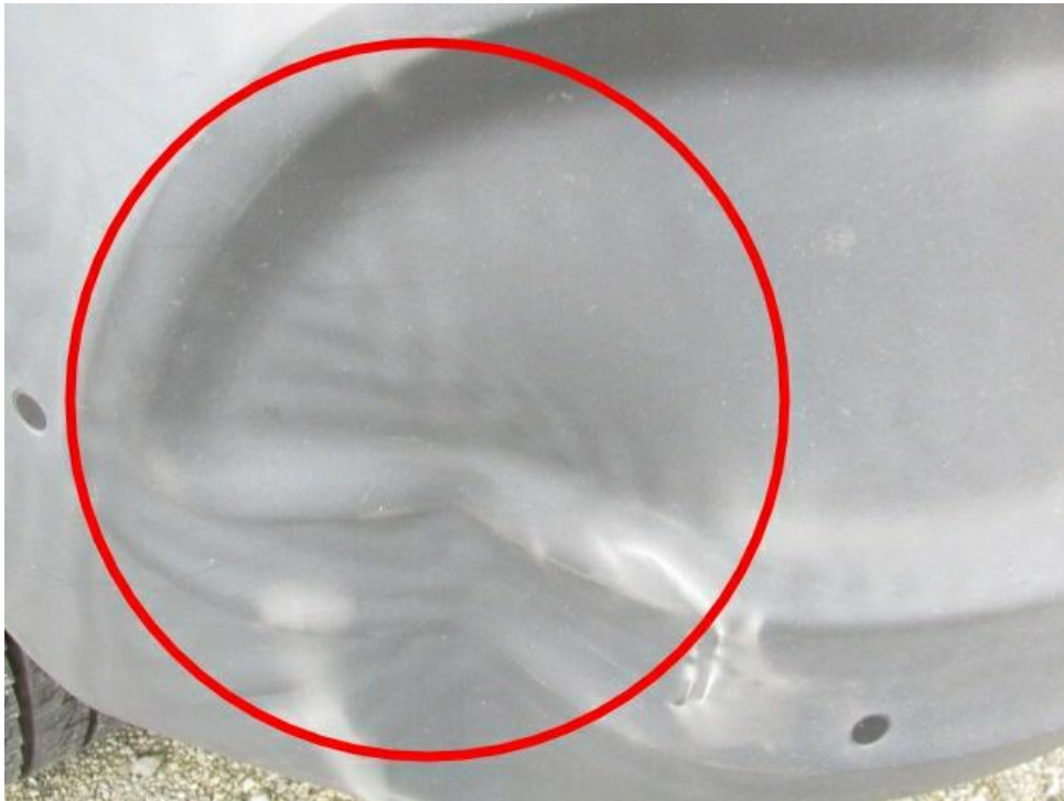
Bild 11 : Stoßfänger vorne bleibend verformt und gerissen
