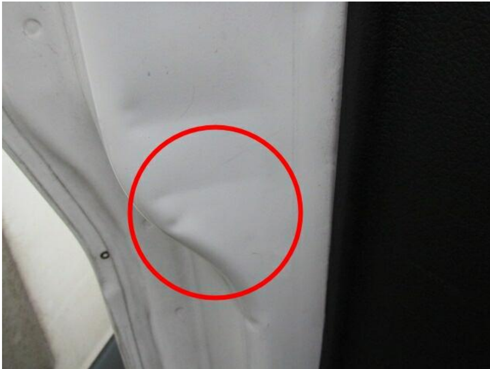
Bild 15 : Türe vorne links innen Dellen
