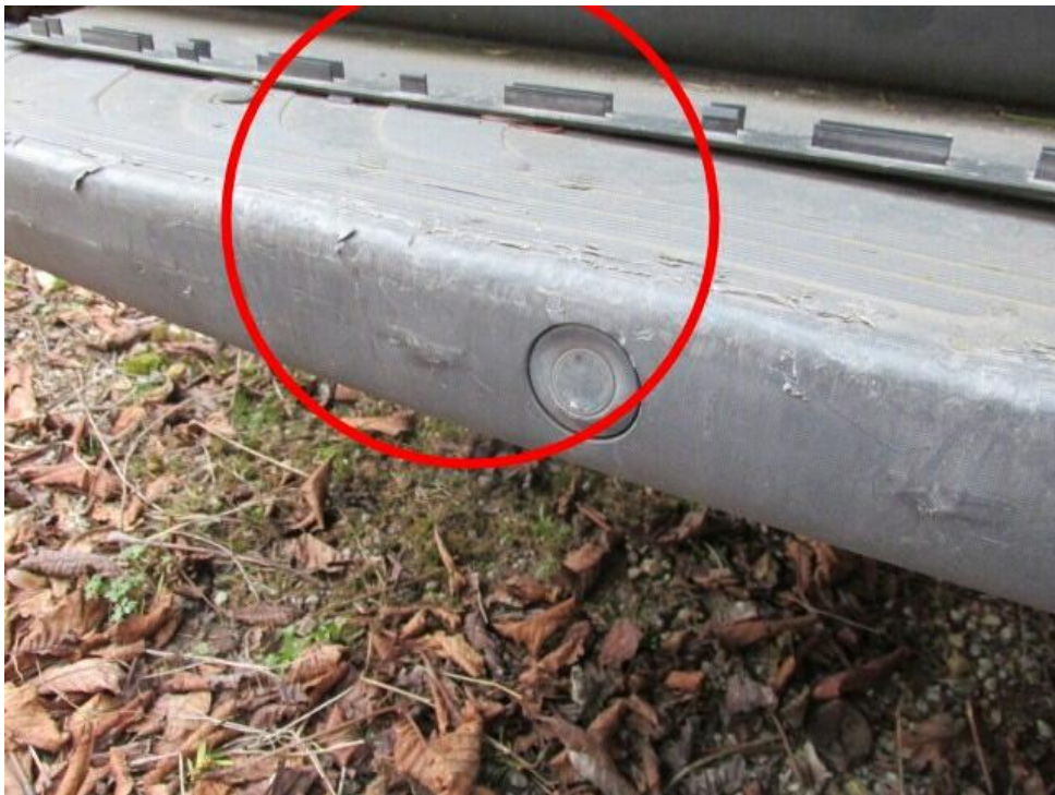
Bild 20 : Trittstufe hinten verformt
