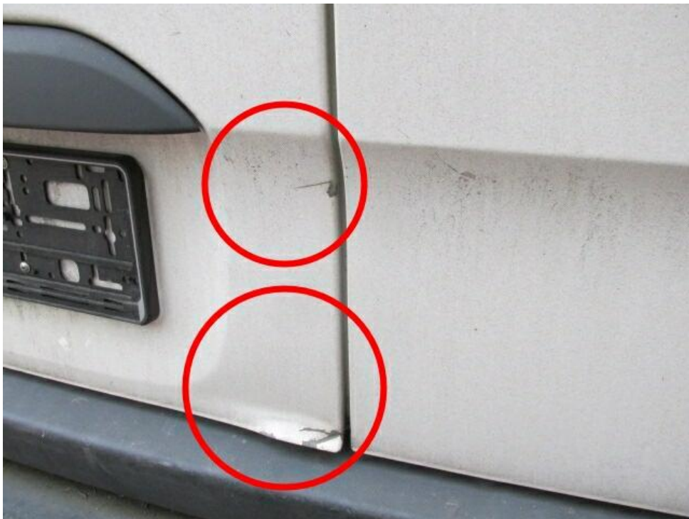
Bild 18 : Türe hinten links im Kantenbereich deformiert
