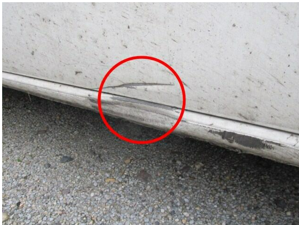
Bild 10 : Schweller rechts deformiert
