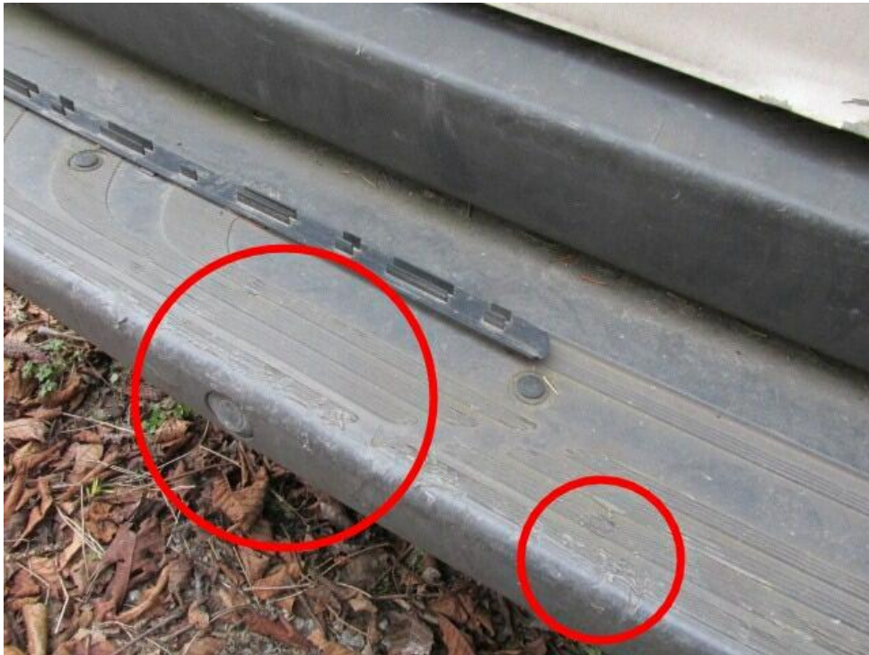
Bild 19 : Trittstufe hinten verformt
