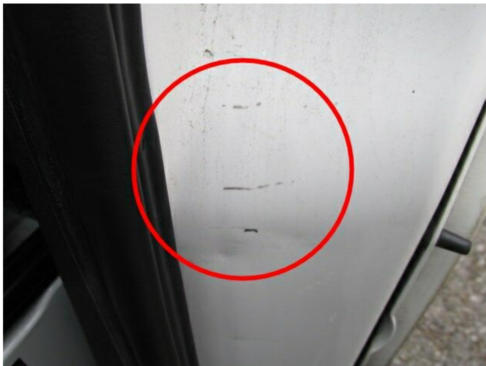
Bild 14 : A-Säule links Kratzern und Dellen
