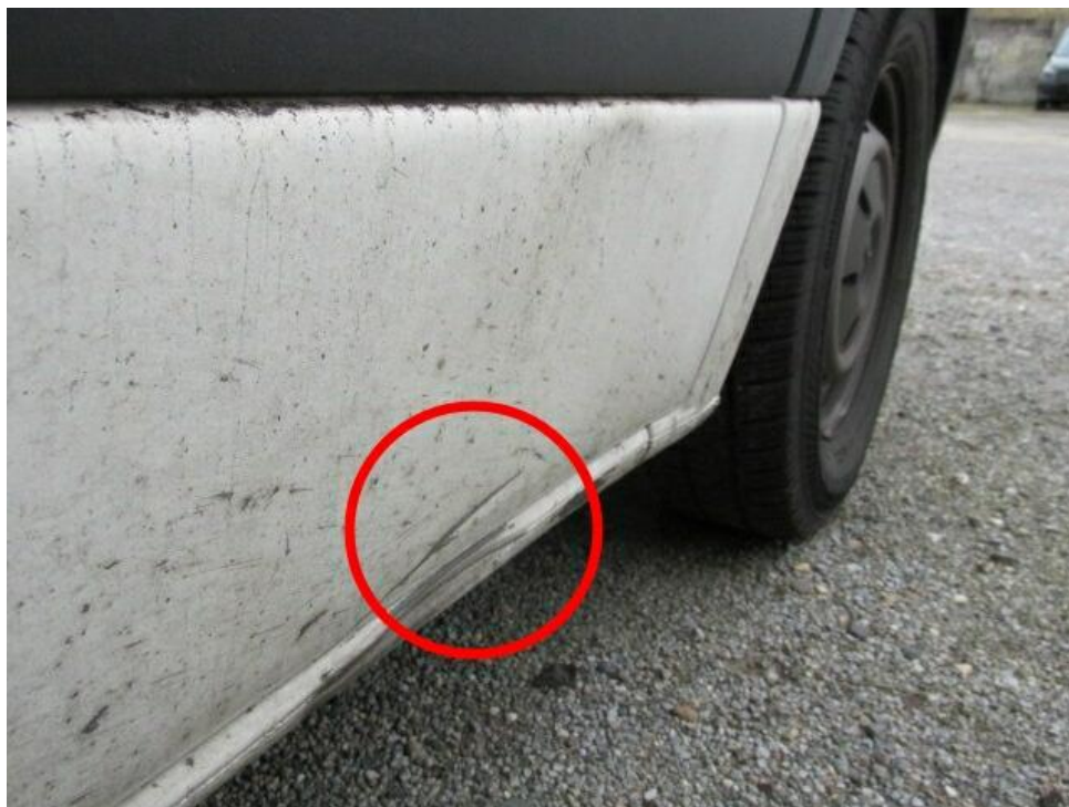
Bild 13 : Türe vorne rechts deformiert
