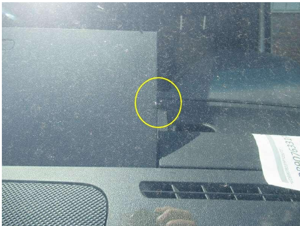
Bild 12 : Windschutzscheibe Steinschlag im Sichtfeld
