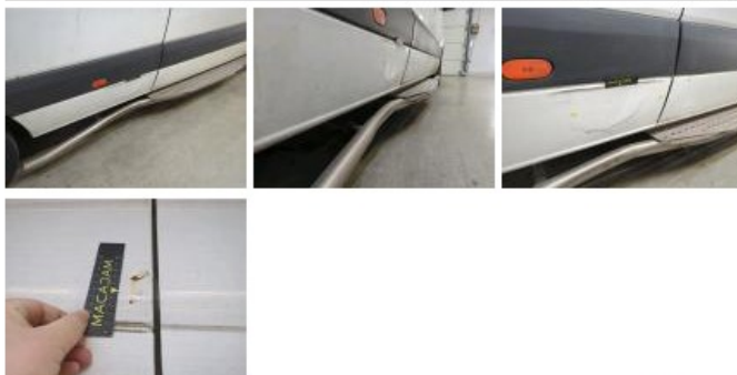
Door catch RR, Broken, Replace
