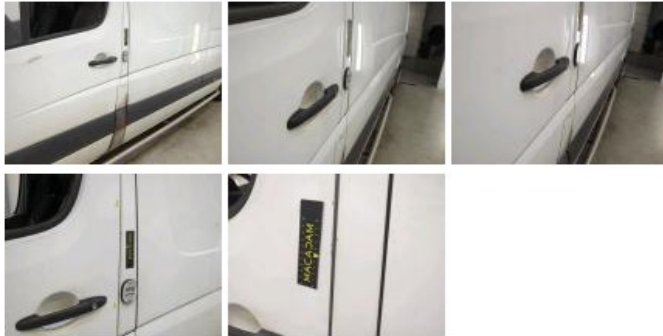
Side bar L, Scratch(es), Replace
