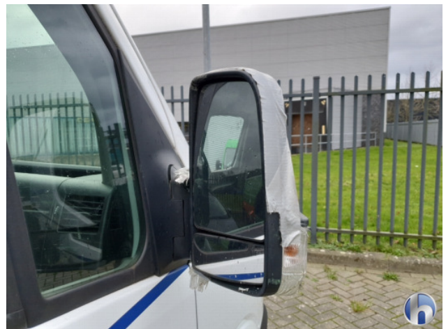
6. Spiegelbehuizing - rechts Breuk / barst / scheur - Vernieuwen
