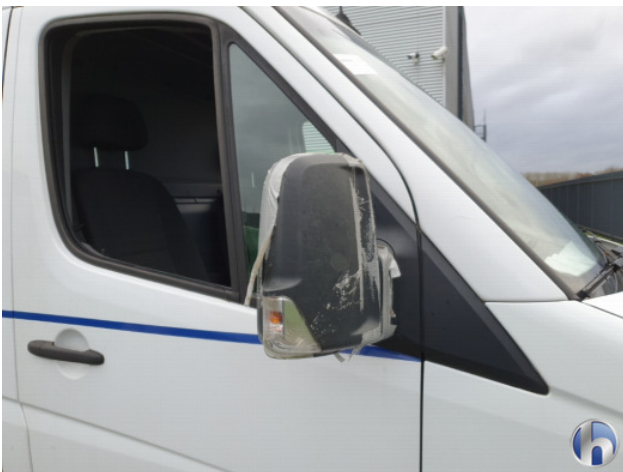
6. Spiegelbehuizing - rechts Breuk / barst / scheur - Vernieuwen
