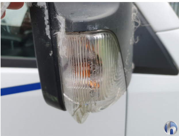
6. Spiegelbehuizing - rechts Breuk / barst / scheur - Vernieuwen
