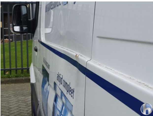
2. Zijwand - achter - Links Deuk/deuken - Herstellen
