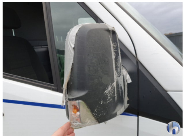
6. Spiegelbehuizing - rechts Breuk / barst / scheur - Vernieuwen
