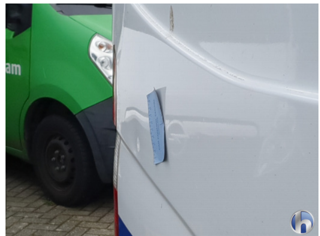
3. Achterklep Deuk/deuken - Herstellen zonder spuiten
