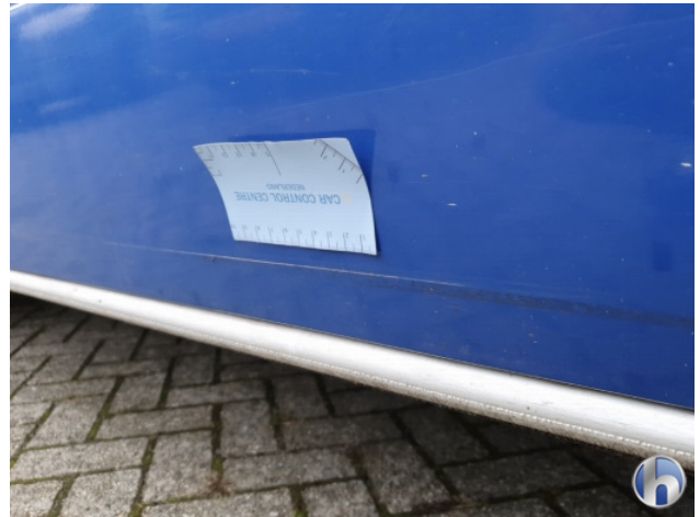
5. Portier achter - rechts Krassen - Vernieuwen
