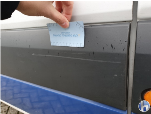
5. Portier achter - rechts Krassen - Vernieuwen
