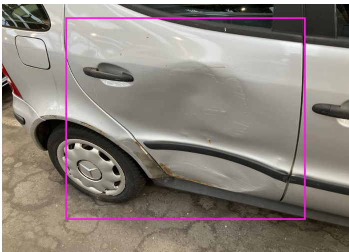
35. Door / Back Right Paint / Corrosion -
