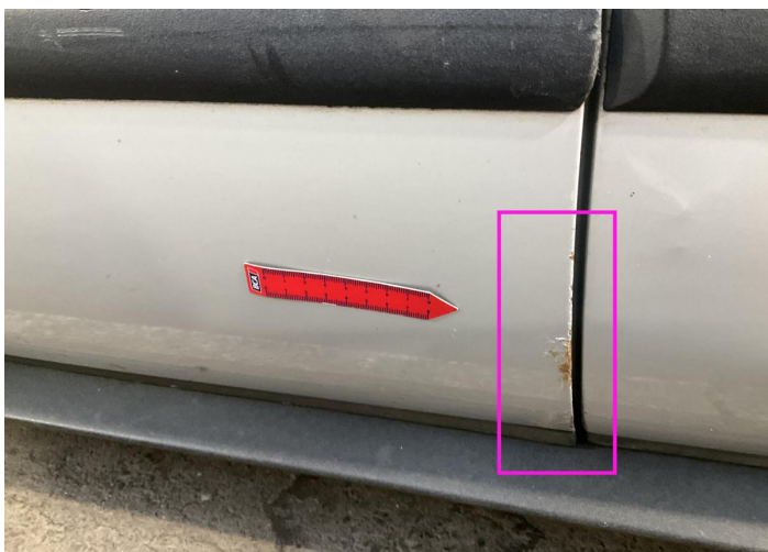
17. Door / Front Left Paint / Corrosion -
