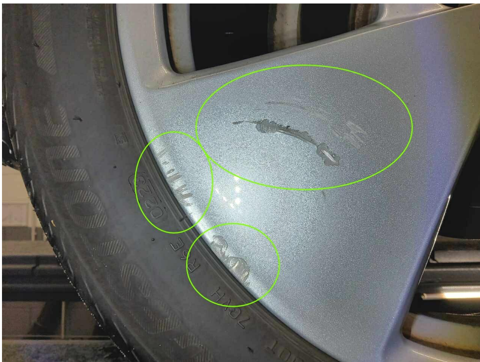
Bild 22 : Leichtmetallfelge hinten rechts mehrfach verschrammt mit Materialabtragung
