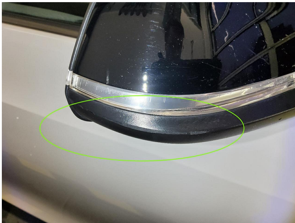
Bild 17 : Spiegelfuß rechts verschrammt
