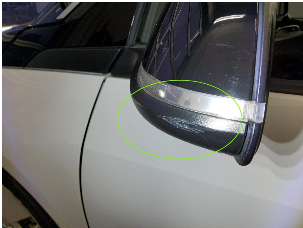
Bild 16 : Spiegelfuß links verschrammt
