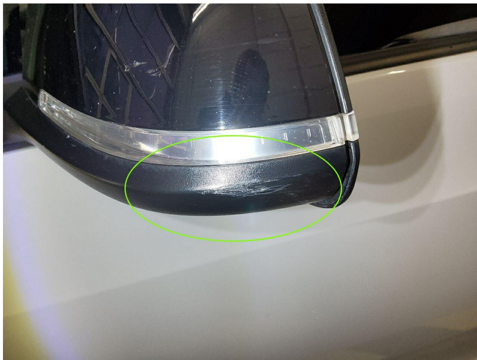
Bild 15 : Spiegelfuß links verschrammt
