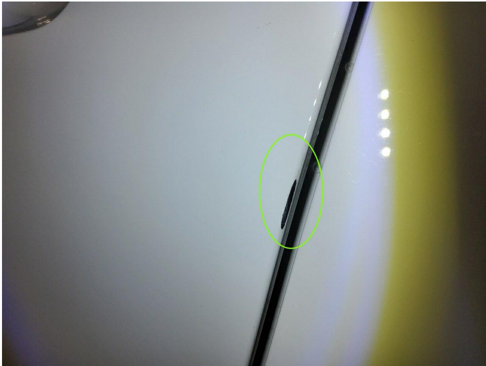
Bild 19 : Türkante vorne links verschrammt
