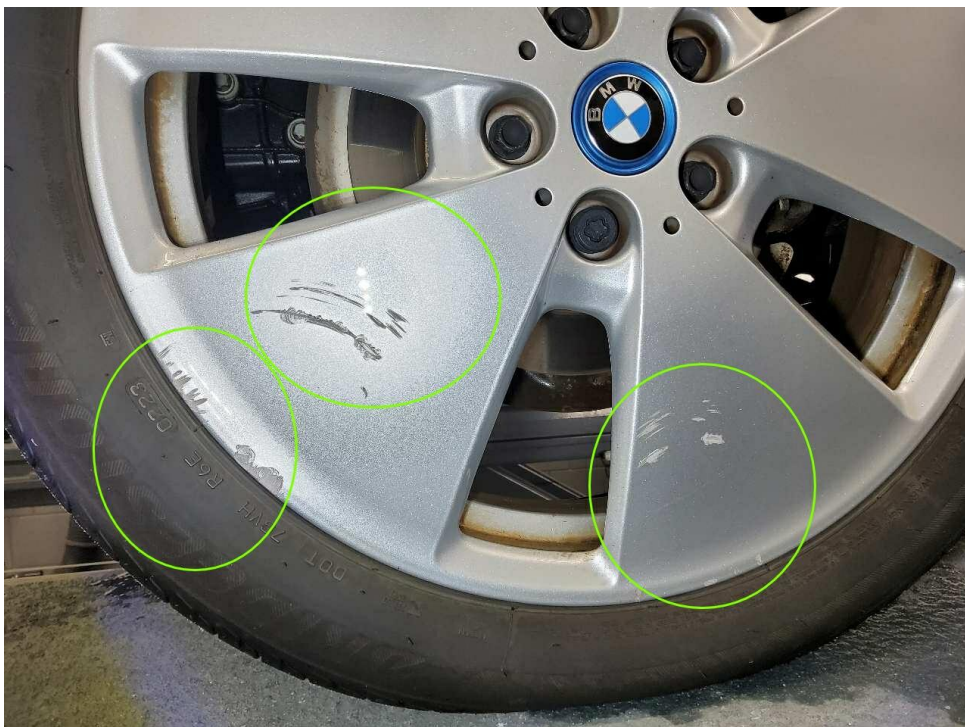
Bild 20 : Leichtmetallfelge hinten rechts mehrfach verschrammt mit Materialabtragung
