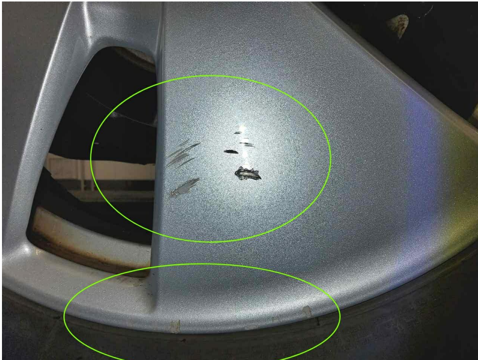
Bild 21 : Leichtmetallfelge hinten rechts mehrfach verschrammt mit Materialabtragung
