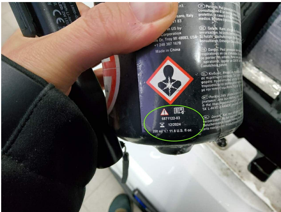
Bild 14 : Reifenpannenset Füllflasche abgelaufen
