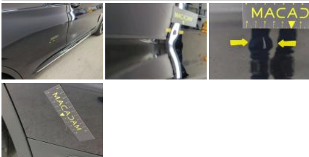
Aile ARD, Griffe(s), LI - Réparer et peindre (complet)
